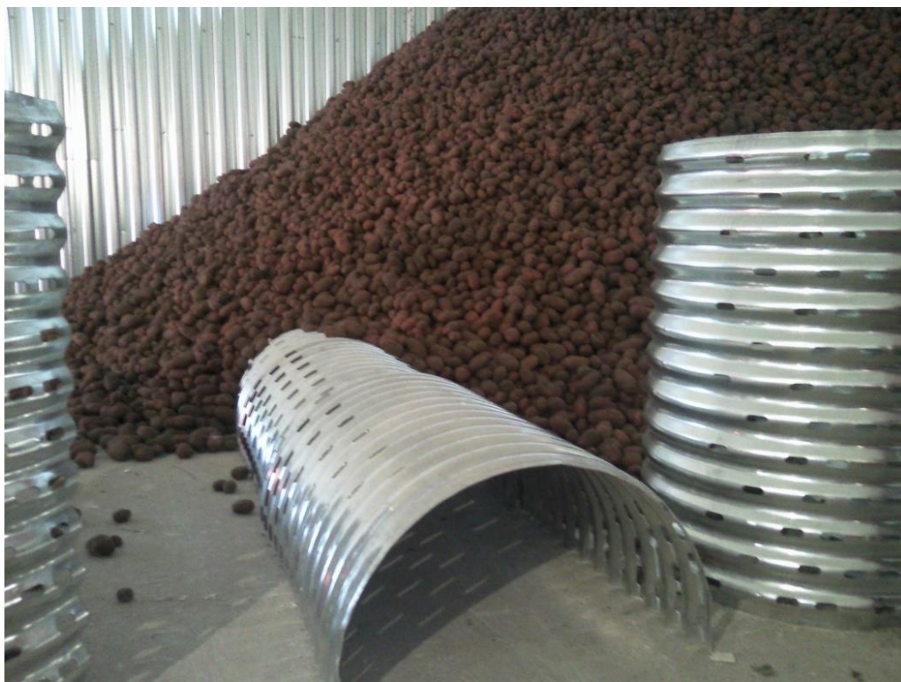
Рисунок 1.4 – Перфорированный напольный канал для вентиляции картофеля
