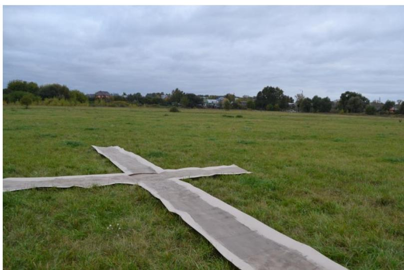
Рисунок 4.10 – Общий вид обработанного пластичной смазкой бумаги для исследования распределения удобрений
