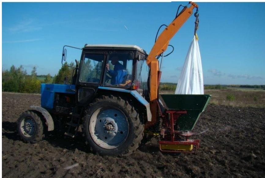
Рисунок 4.16 – Самозагружающаяся машина для внесения удобрений СЗМВУ-0,5
