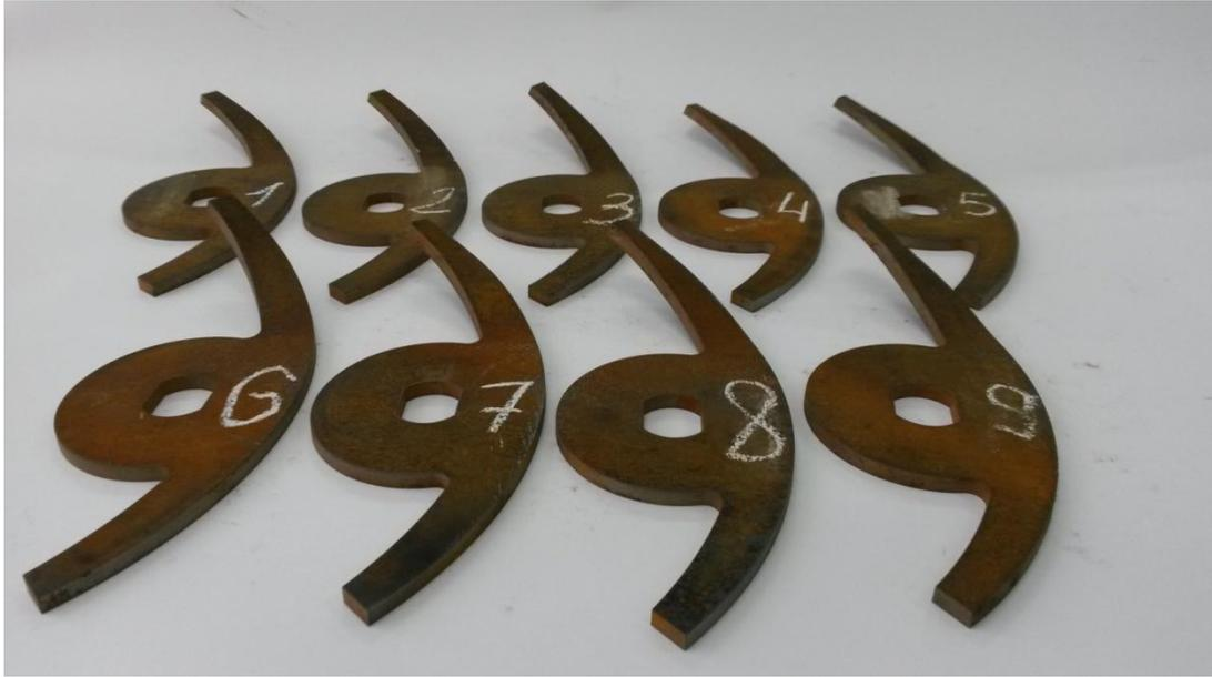
Рисунок 4.3 –Ворошители с разными углами подъема и поворота лопасти
