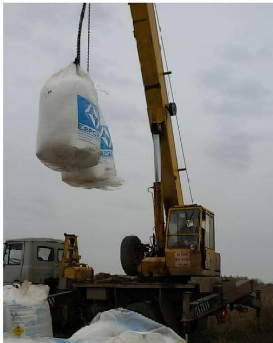
Рисунок 4.13 – Погрузка мягких контейнеров типа «Биг-Бэг» в прицеп
