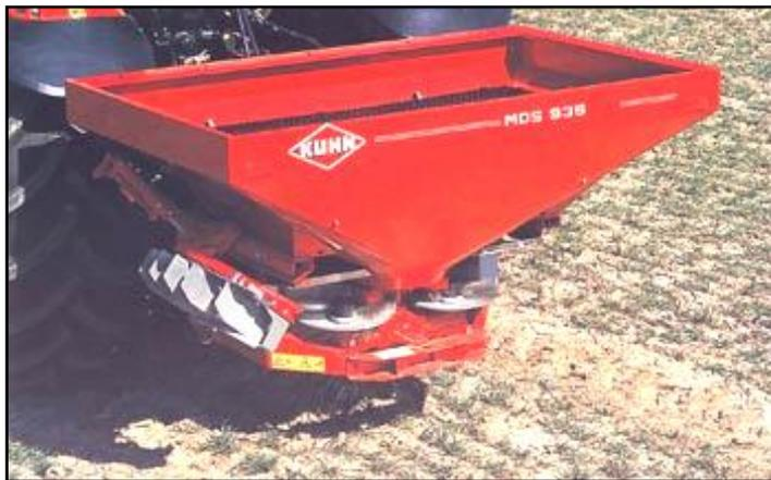
Рисунок 1.1 – Центробежная двухдисковая машина MDS
