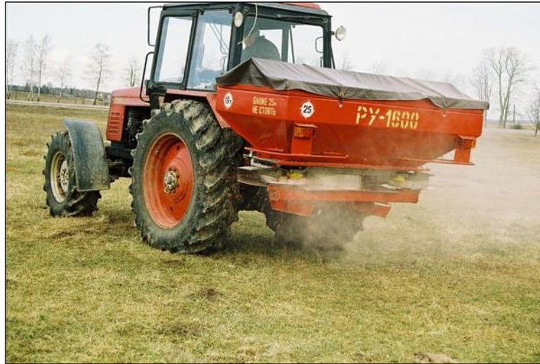
Рисунок 1.6 – Машина для внесения минеральных удобрений PY-1600.
