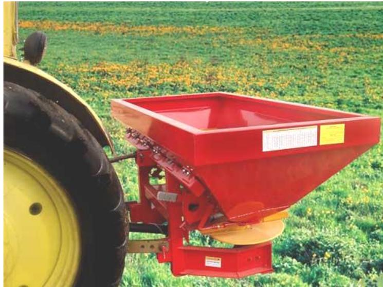
Рисунок 1.4 – Машина для внесения минеральных удобрений МВУ-900
