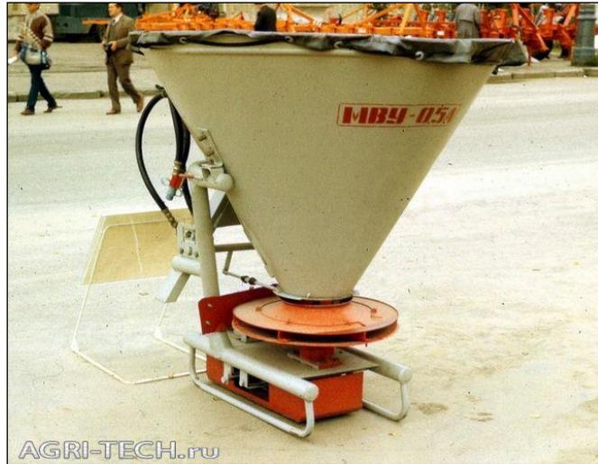
Рисунок 1.8 - Машина для внесения минеральных удобрений МВУ-0,5А
