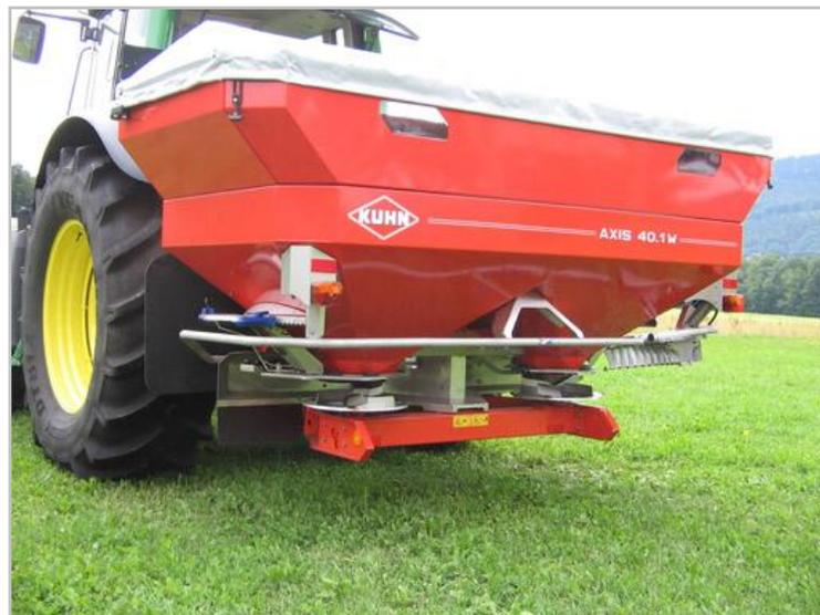
Рисунок 1.2 – Центробежная двухдисковая машина AXIS
