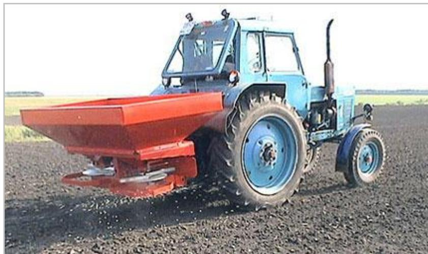
Рисунок 1.5 - Машина для внесения минеральных удобрений МВУ-1200
