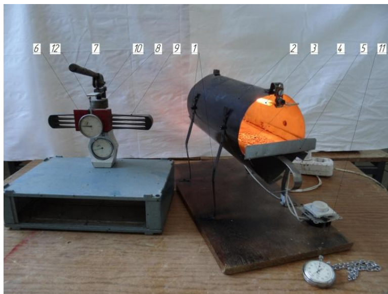
1 – опорные стойки; 2 – кожух-отражателя; 3 – Лампа ИК-излучателя (КГТ-220-1000); 4 – зерно; 5 – металлический лист; 6 – индикатор; 7 – рукоятка; 8 – пресс форма; 9 – динамометрическая пружина; 10 – пуасон; 11 – секундомер; 12 – шток;
