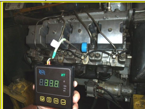
Иллюстрация 2 – Измерительный блок температуры в камеры сгорания
