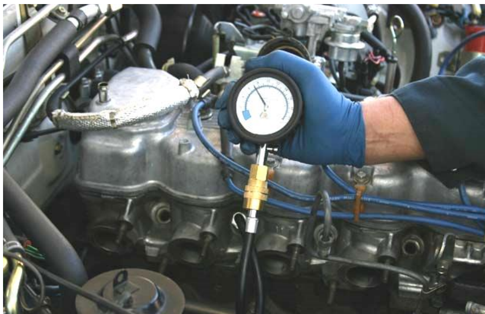
Рисунок 1.3 – Измерение компрессии в двигателе
