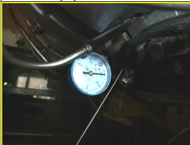
Иллюстрация 5 – Установка устройства и измерение компрессии
