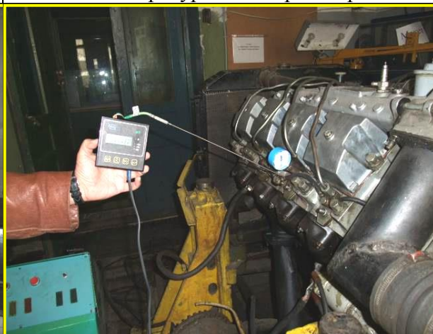
Иллюстрация 4 – Измерение температуры в камере сгорания ДВС
