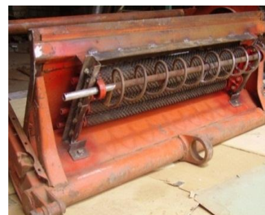
1 – бите́р проставки, 2 – пальчиковый механизм, 3 – планки, 4 – ремни, 5 – ролики, 6 – кожух, 7 – зерновой шнек, 8 – цепная передача Рисунок 9 – Схема модернизированной проставки
