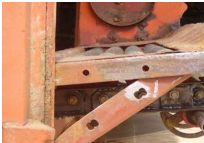
Рисунок 4.4 - Место установки транспортирующих роликов и шнека
