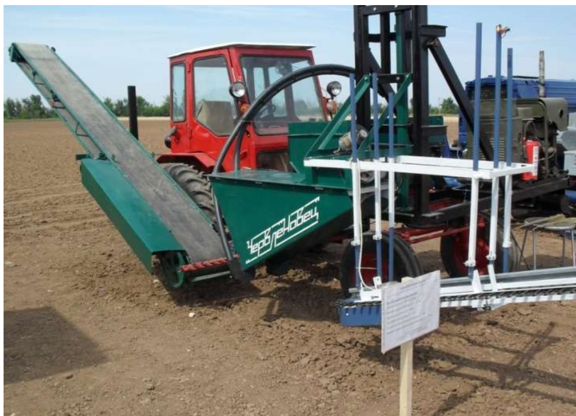
Рисунок 5.2 - Фотография одномодульной уборочной машины с МСУ инерционно-очесного типа
