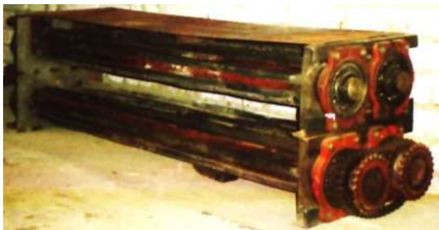
Рисунок 4.16 - Устройство частичного вымолота зерна из скошенной зерносоломистой массы
