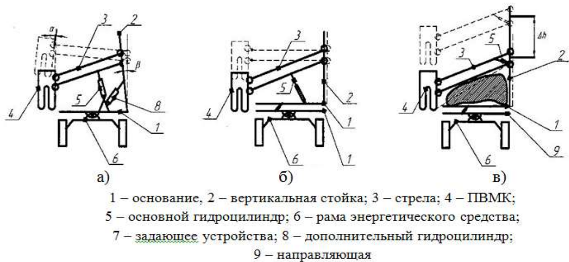
Рисунок 5.8 – Схемы навесных устройств с подвижной вертикальной стойкой
