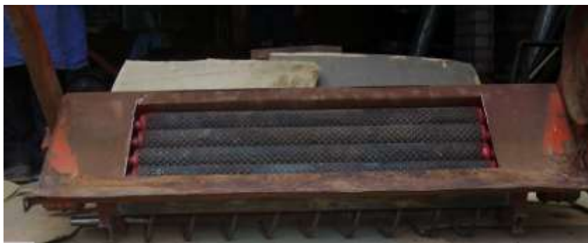
Рисунок 4.6 - Комплект транспортирующих роликов, установленных в корпусе проставки
