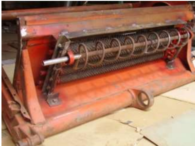
Рисунок 4.3 - Шнек для транспортировки вымолоченного зерна
