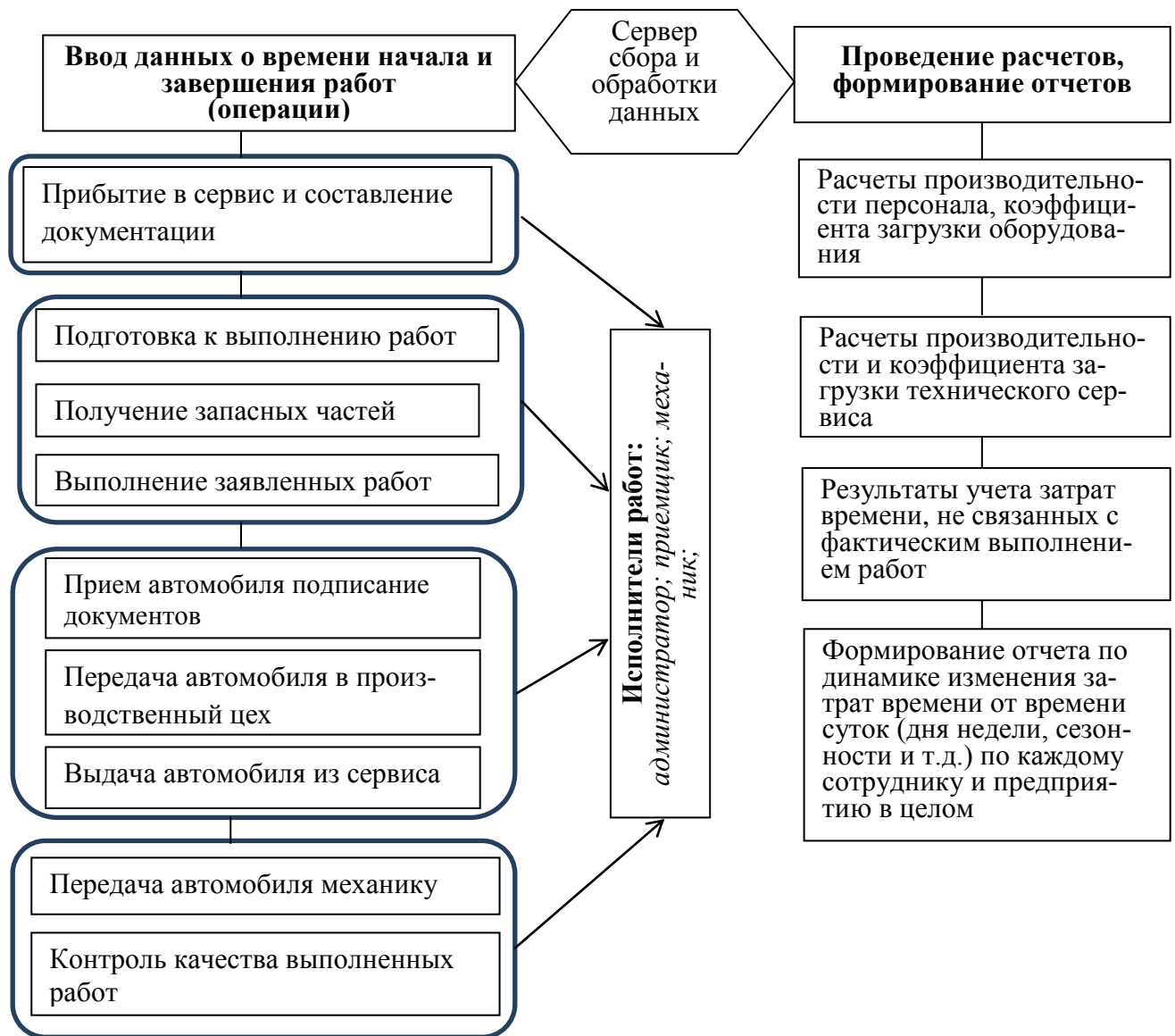
Рисунок 2.2 – Блок-схема информационных потоков системы учета рабочего времени
