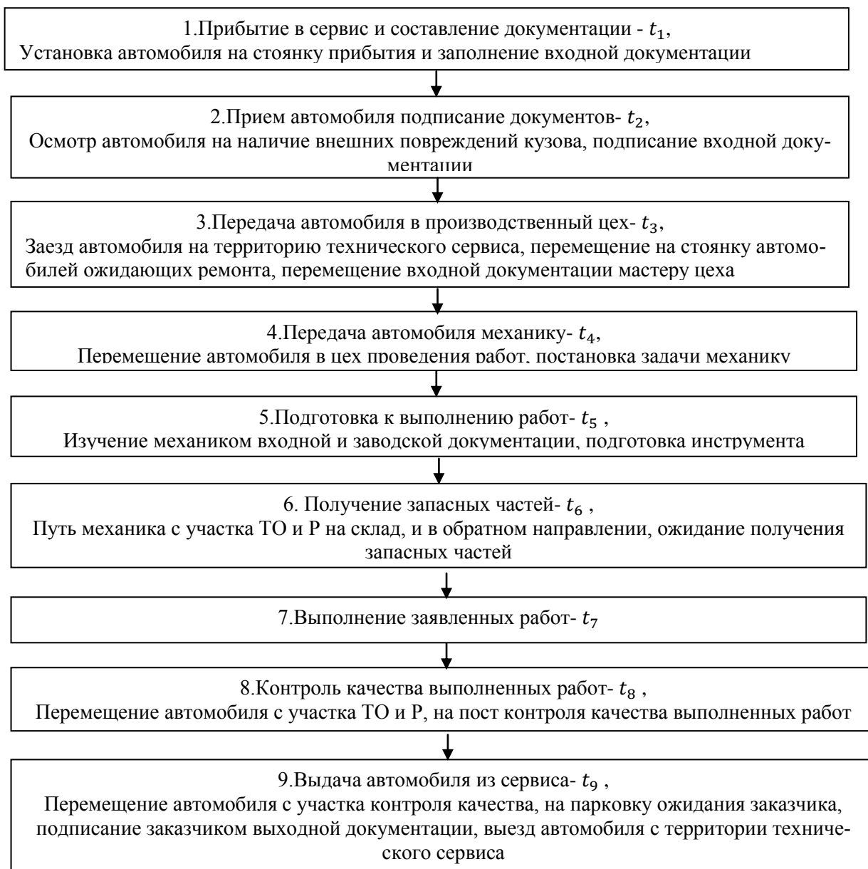
Рисунок 2.1 – Структура основных работ по техническому сервису машин.
