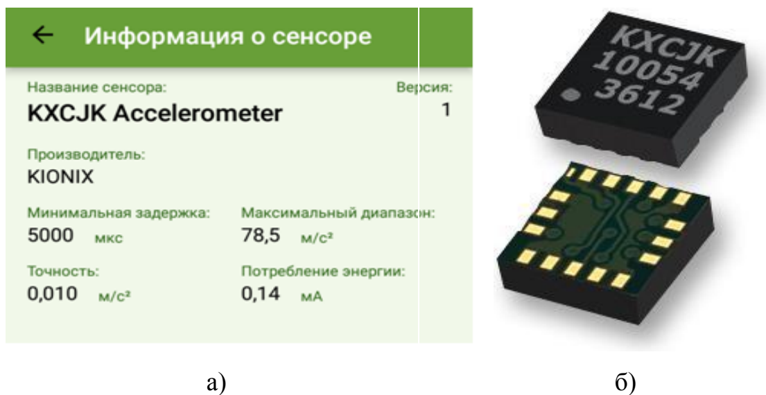
Рисунок 3.5 – Акселерометр KXCJK-10054 , а) технические характеристики акселерометра; б) общий вид акселерометра KXCJK-10054
