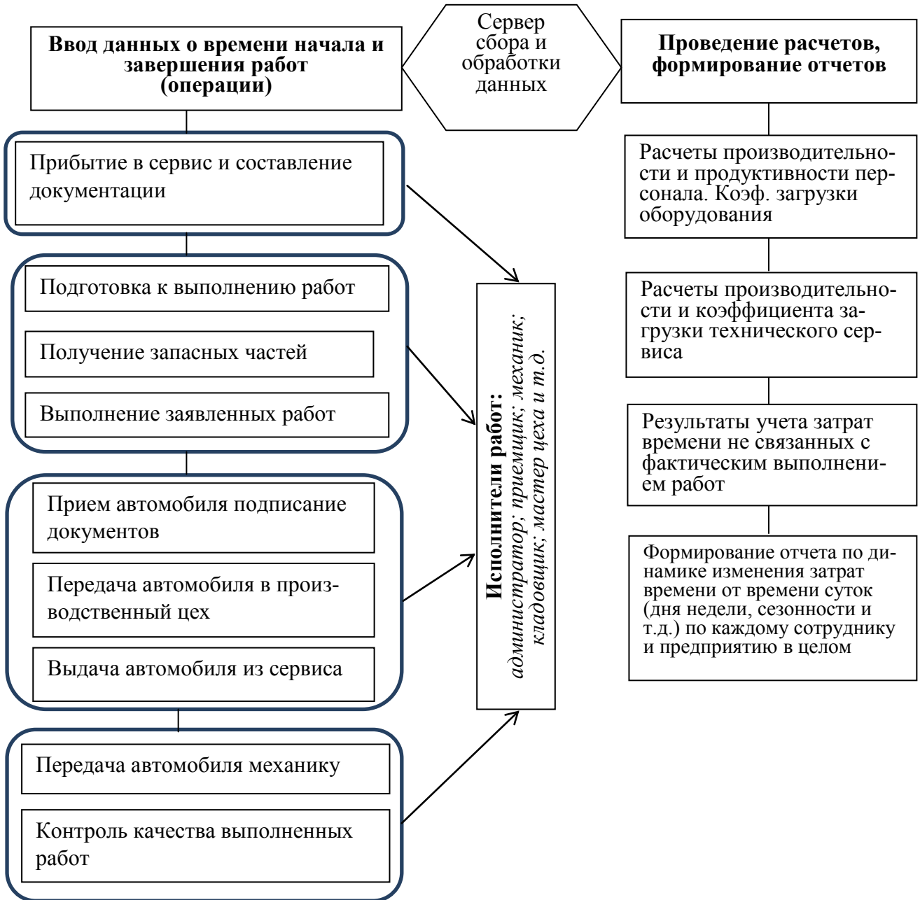
Рисунок 2.4 – Схема информационных потоков системы "Учета рабочего времени"
