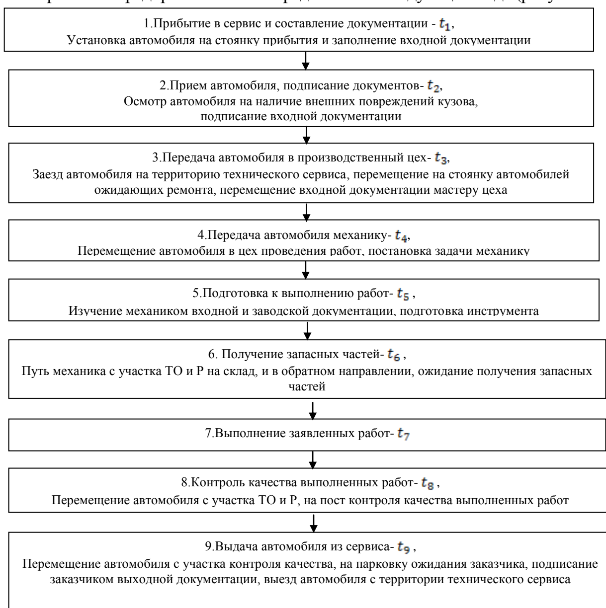
Рисунок 2.3 – Структура организации основных работ по техническому обслуживанию и ремонту машин
