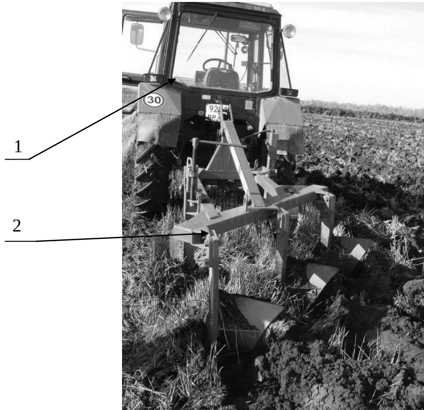
Рисунок 3.12 – Машинно-тракторный агрегат на вспашке.
