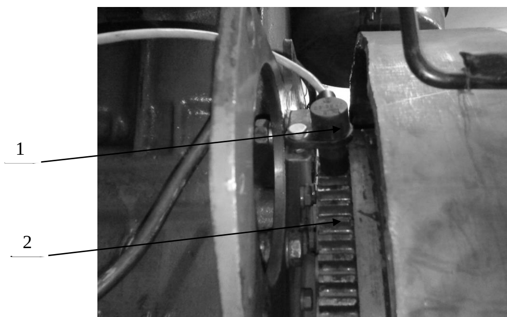
Рисунок 3.9 – Установка датчика положения коленчатого вала.
