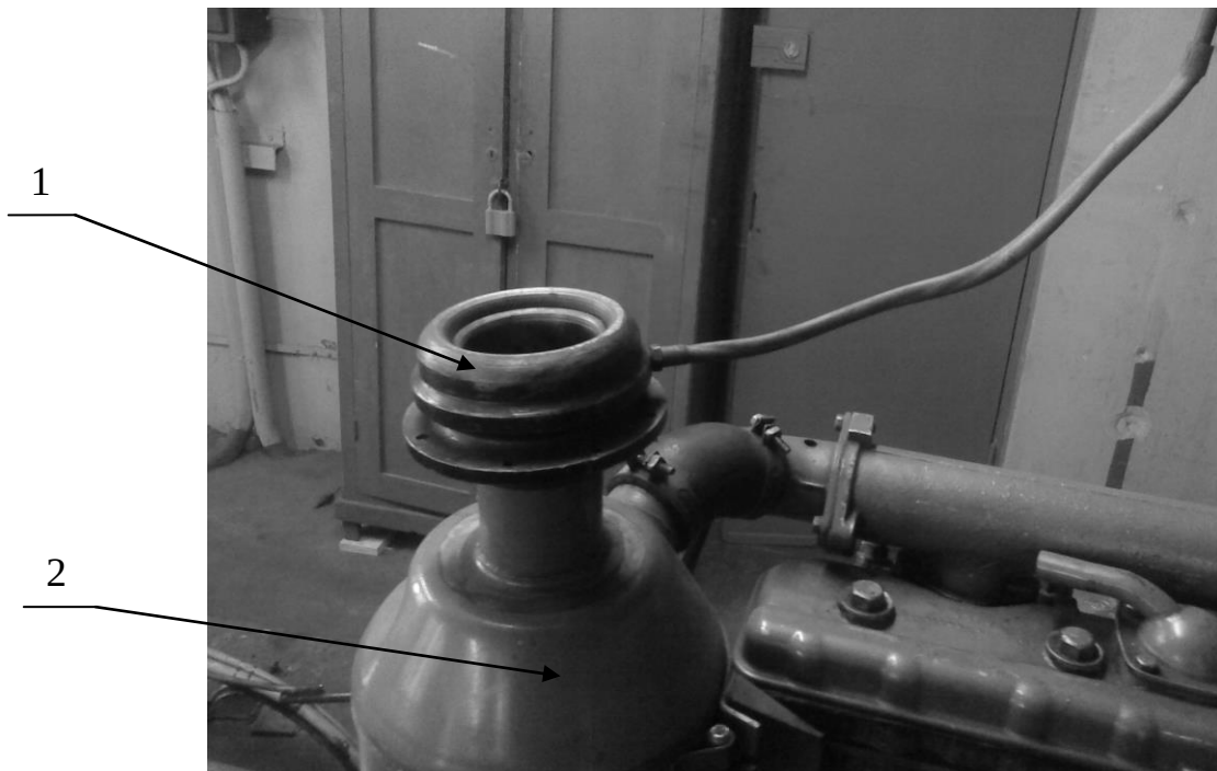
Рисунок 3.7 – Установка измерительного насадка.
