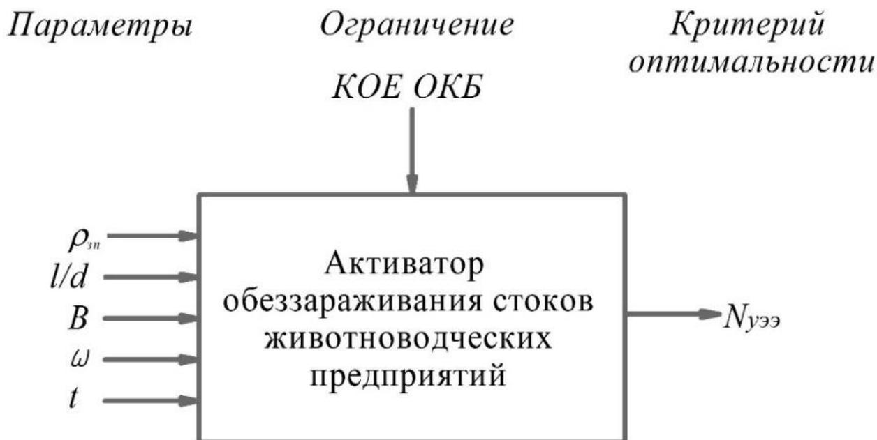
Рисунок 12 – Блок-схема модели системы при оптимизации
