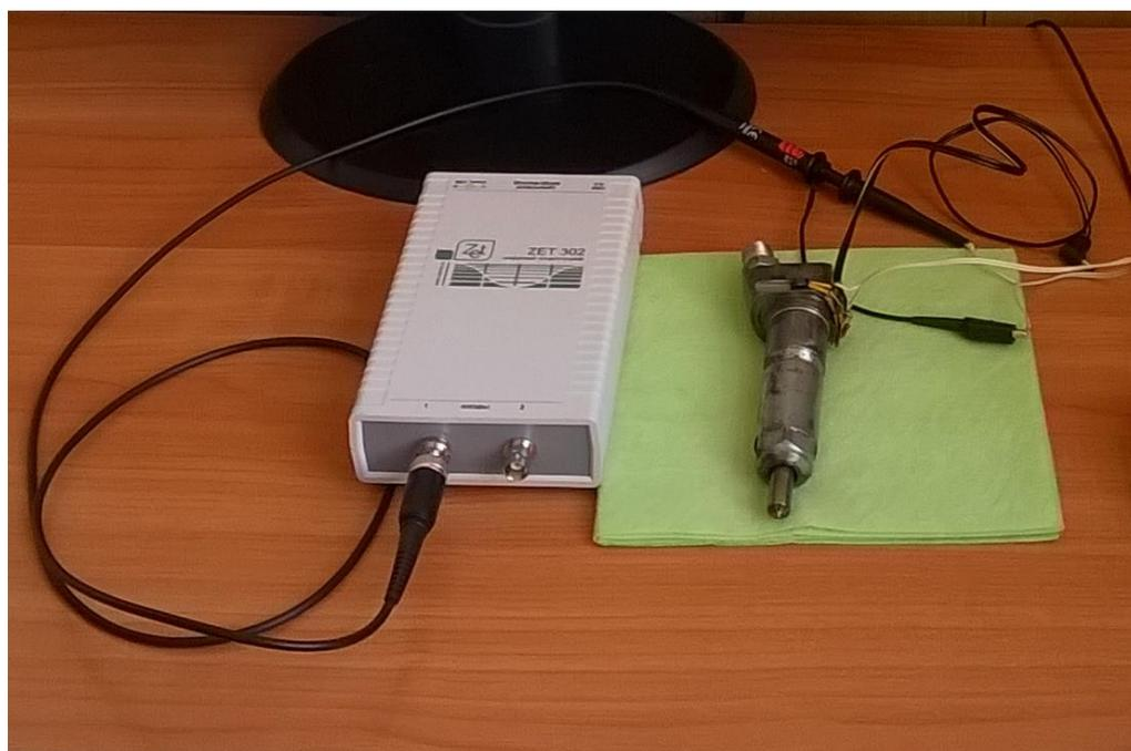
Рисунок 4.1 – Устройство диагностирования ТА дизеля:
