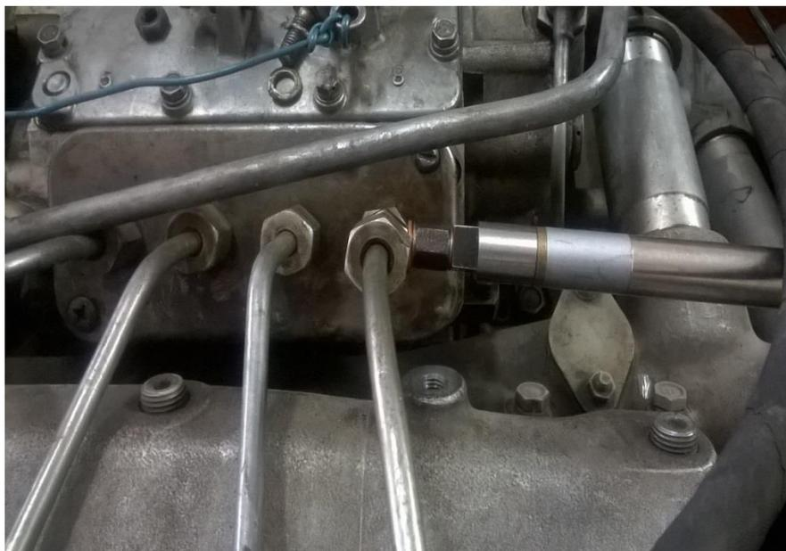
Рисунок 3.6 – Установка датчика давления топлива в систему топливоподачи дизеля КАМАЗ-740.11-240
