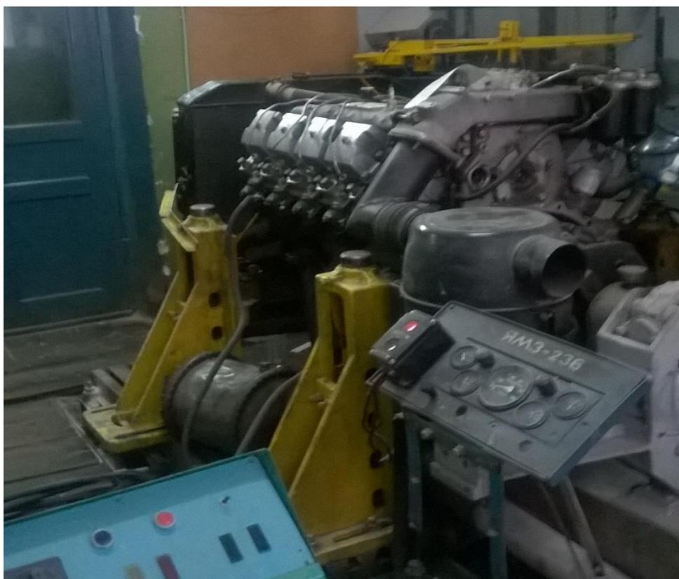
Рисунок 3.4 – Внешний вид стенда с двигателем КАМАЗ 740.11-240
