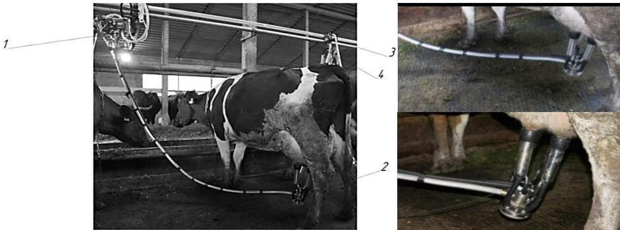
1 – модуль управления доением; 2 – испытуемый доильный аппарат; 3 – молокопровод; 4 - вакуумопровод
