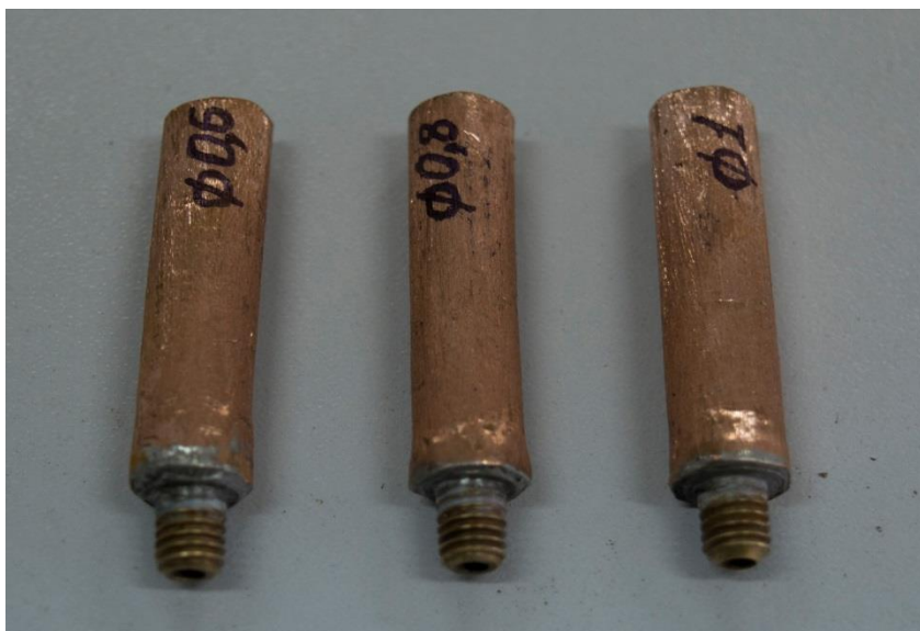
Рисунок 3.15 - Сменные штуцеры для подачи воздуха в коллектор разных диаметров
