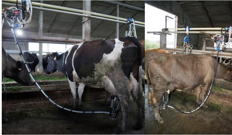
Рисунок 4.4 - Общий вид доильной установки с испытуемым доильным аппаратом во время доения
