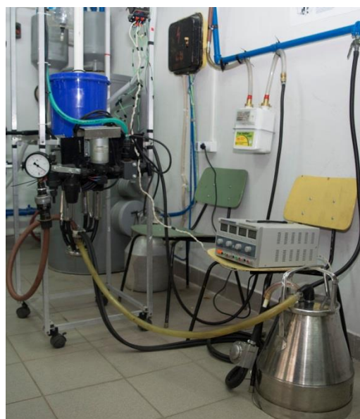
Рисунок 3.18 – Вид лабораторной установки с прибором КИ-4840
