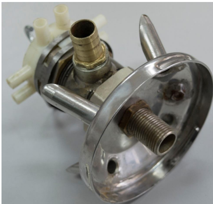
Рисунок 3.6 - Вид коллектора для лабораторных испытаний без крышки молокосборной камеры.
