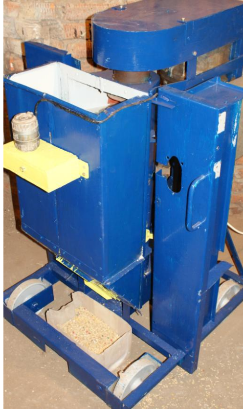
Рисунок 4.1 – Промышленный образец смесителя концентрированных кормов во время производственных испытаний
