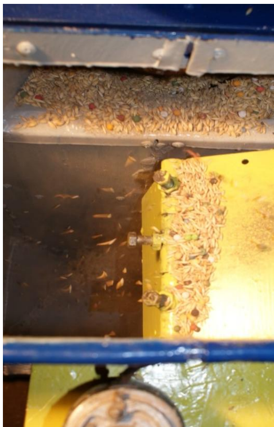
Рисунок 3.6 – Механический активатор процесса смешивания в сборе
