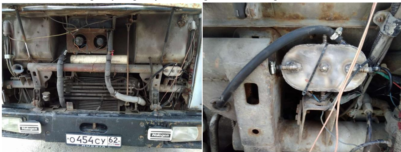
Рисунок 7 - Расположение камеры ультразвуковой обработки топлива под капотом автомобиля МАЗ-4370
