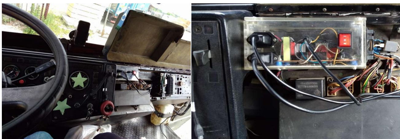
Рисунок 7 - Расположение камеры ультразвуковой обработки топлива под капотом автомобиля МАЗ-4370
