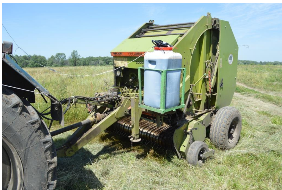
Рисунок 3.11 – Общий вид установки для внесения гуматов смонтированной на пресс-подборщике
