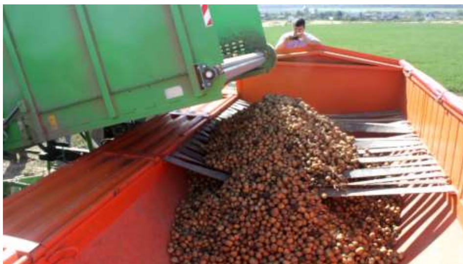
Рисунок 1.16 – Момент загрузки картофеля в кузов «Гранд – Полевик», оснащенный ремнями-гасителями
