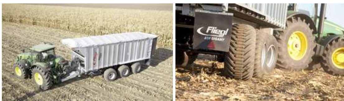
Рисунок 4.8 – Тракторный поезд с системой электронного принудительного подруливания „ForCon“
