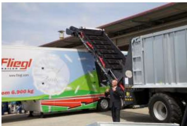
Рисунок 4.2 – Общий вид перегружающей ленты Fliegl Pom-Over для картофеля, установленной на прицепе - вагоне ASW
