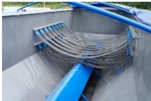
Рисунок 1.19 – Кузов полуприцепа «Тонар – 95235» с установленными ударогасящими ремнями и защитой донного транспортера
