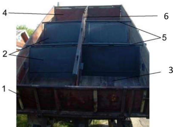
Рисунок 2.14 - Усовершенствованный самосвальный кузов для транспортировки картофеля с поля [214, 250]
