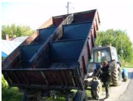
Рисунок 3.2 - Усовершенствованный самосвальный кузов тракторного прицепа 2 ПТС-4
