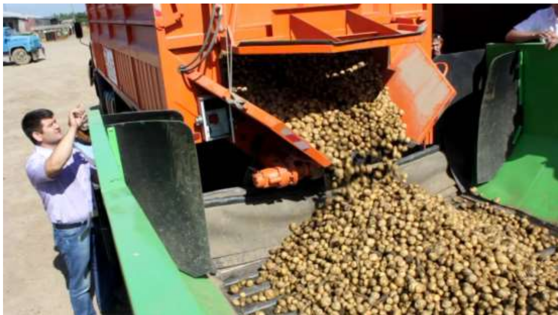
Рисунок 1.17 – Выгрузка картофеля из кузова «Гранд – Полевик» ленточным транспортером
