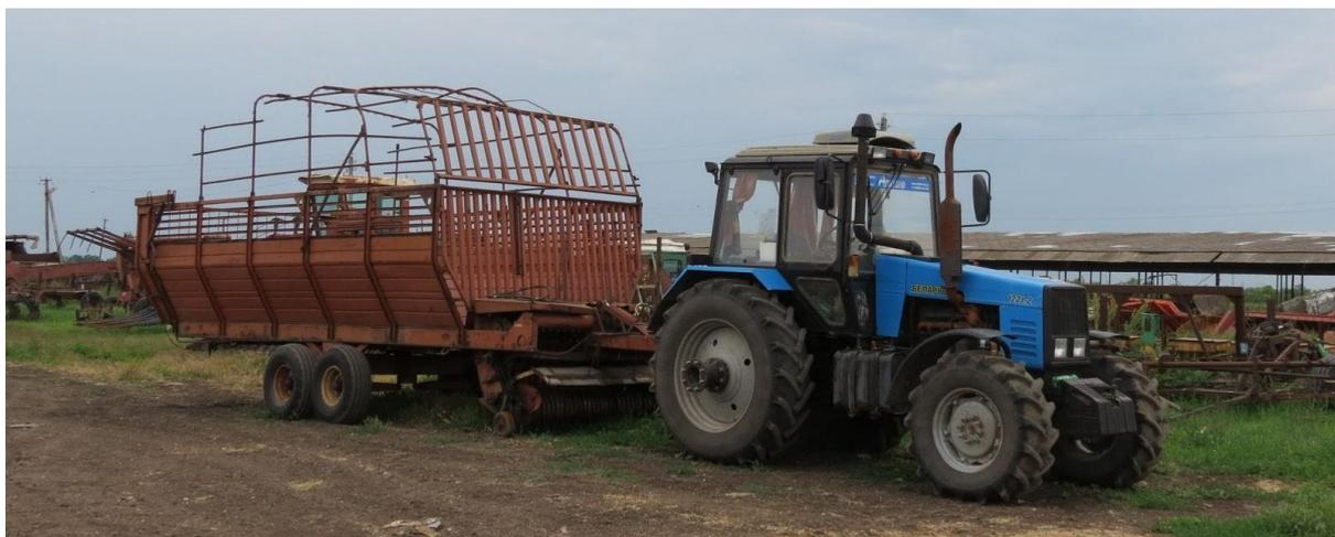
Рисунок 1 – Полуприцеп-подборщик ТП-Ф-45 в агрегате с трактором МТЗ-1221
