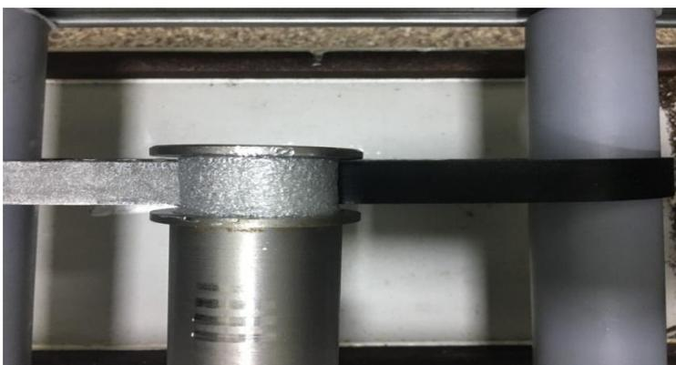
Рисунок 3. – Нанесение консерванта на приводный ремень.
