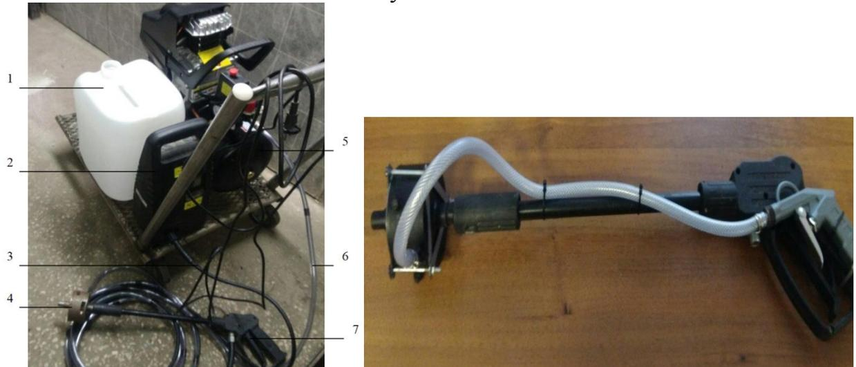
1 - емкость для воды, 2 – насоса высокого давления, 3 – напорный шланг высокого давления, 4 – экспериментальное сопло, 5 – компрессор, 6 – воздушный шланг, 7 – манометр моечной установки.
