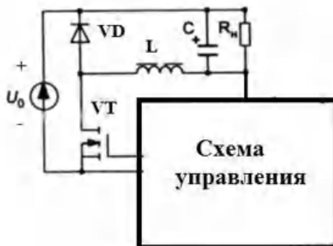
Рис. 1. Функциональная схема однотактного преобразователя понижающего типа
