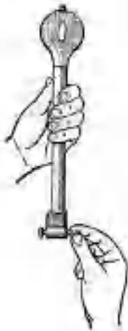
Рисунок 6 Настройка на требуемый диапазон измерения
