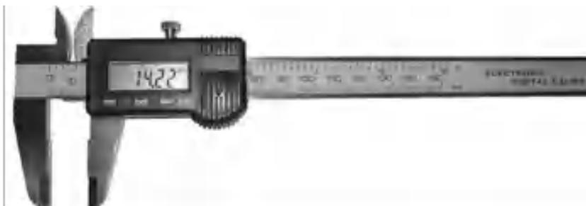
Рисунок 4 – Штангенциркуль с отсчетом по электронно-цифровой шкале
