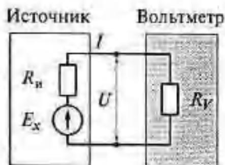
Рис. 1. Погрешность взаимодействия вольтметра и источника напряжения
