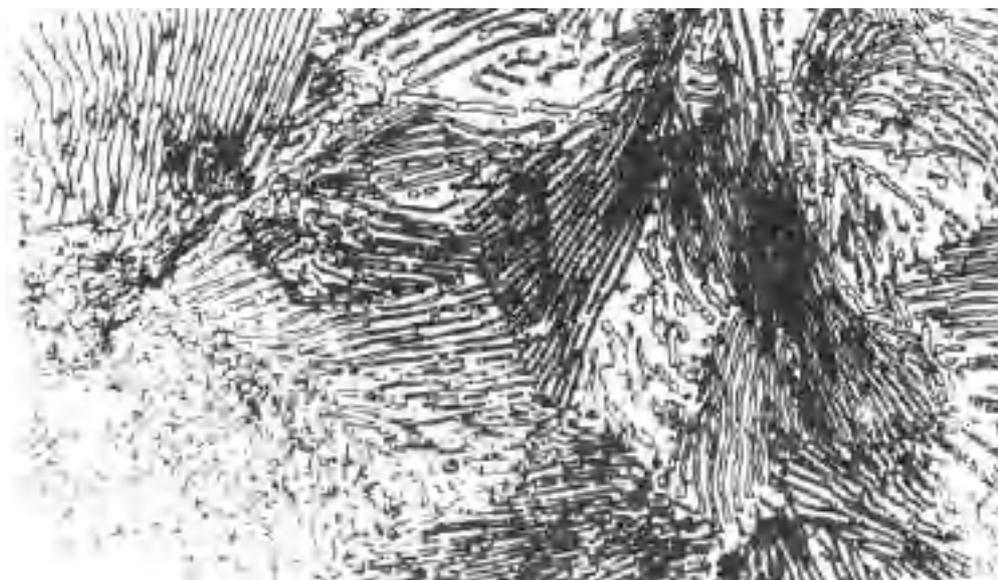
Рисунок 8.2. Микроструктура пластинчатого перлита x500
