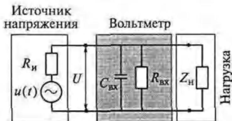
Рис. 3 Погрешность взаимодействия прибора и источника периодического напряжения
