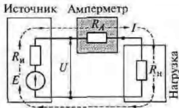
Рис. 2. Влияние амперметра на ток в цепи
