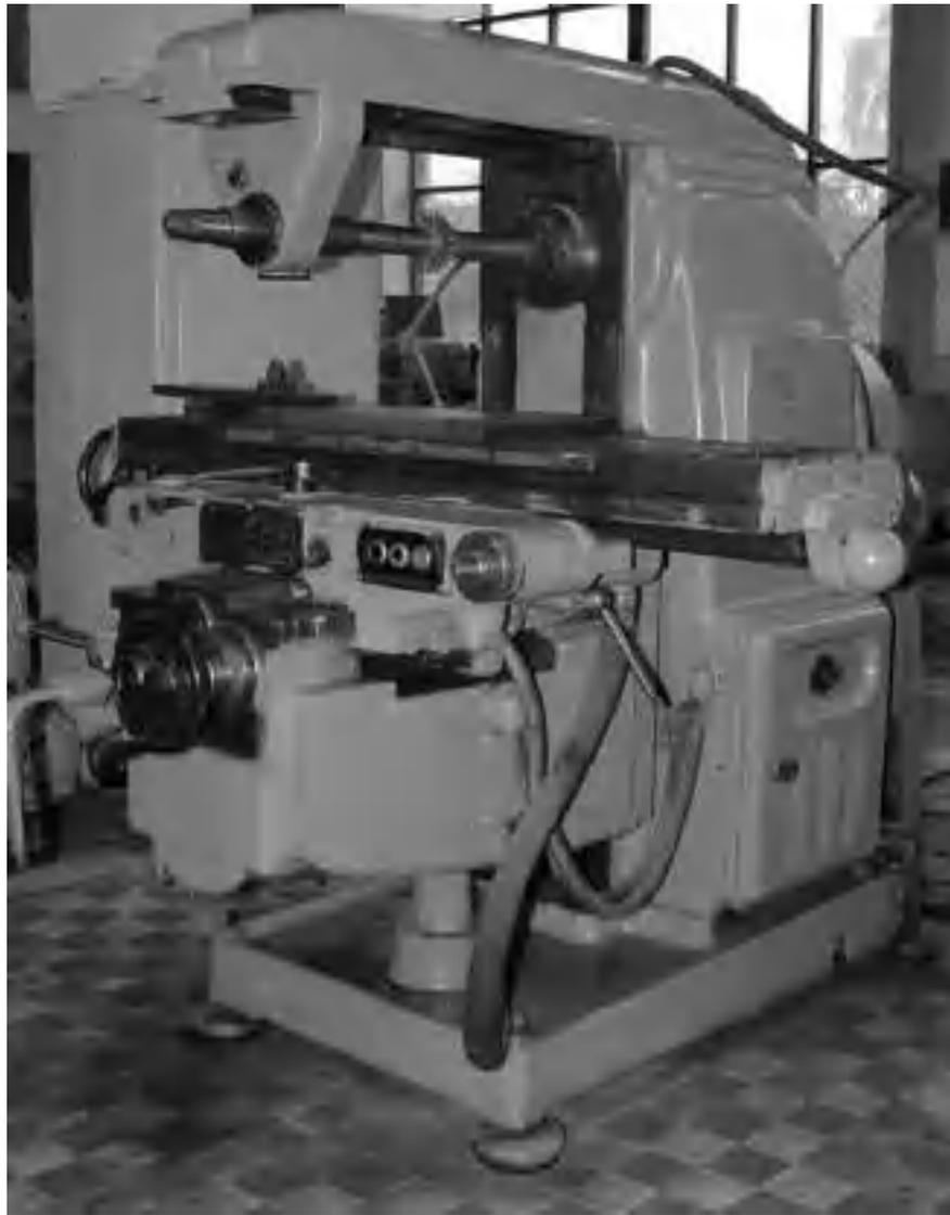
Рисунок 16.1. Общий вид горизонтально-фрезерного станка модели 6H81Г
