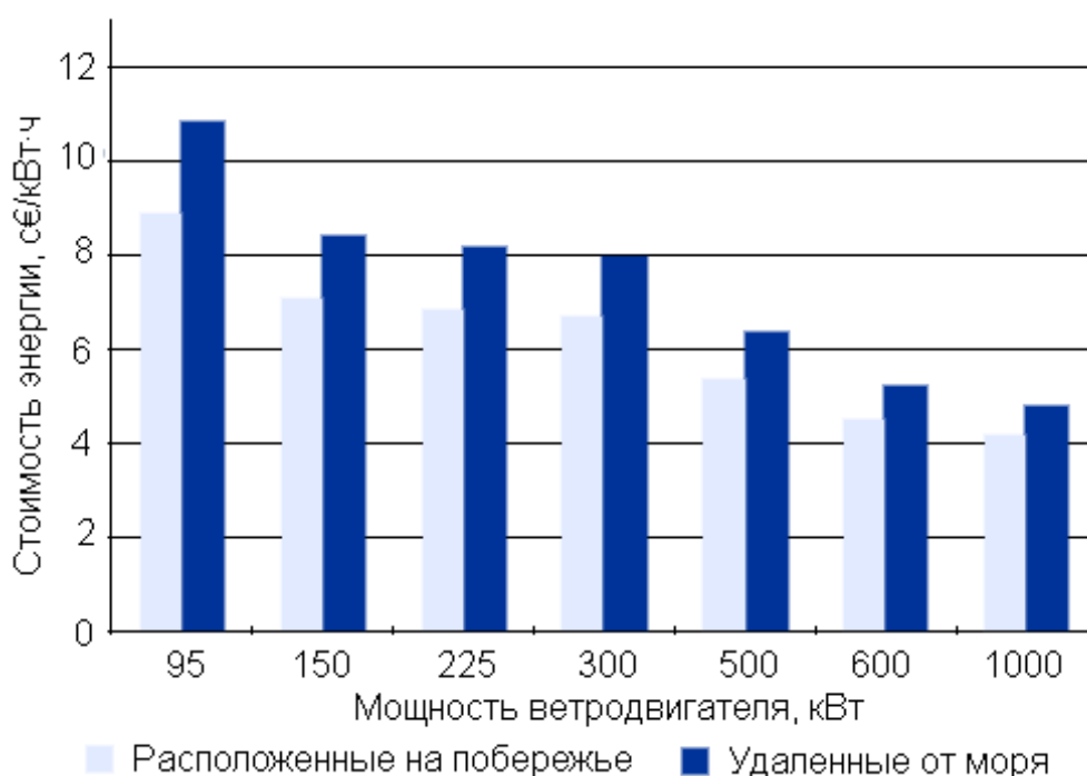
Рисунок 4.6 – Зависимость стоимости электроэнергии от мощности ветродвигателей при их расположении на побережье и вдали от моря
