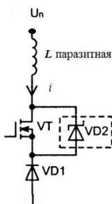
1. Защиты ключевого транзистора от эдс самоиндукции создаваемой индуктивностями монтажных проводников при резком изменении тока в цепи
