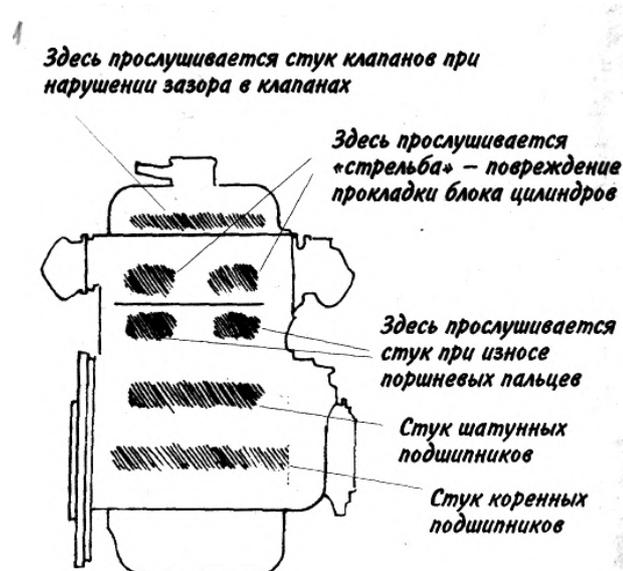
Рис.4. Места прослушивания стуков в двигателе
