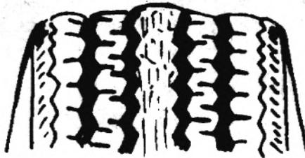
Рис.6. Повышенное давление воздуха в шинах.
