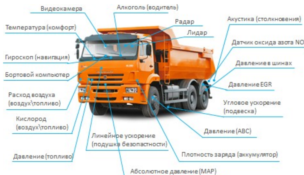
Рис. 3. Элементы МЭМС в реализации беспилотного КАМАЗа
