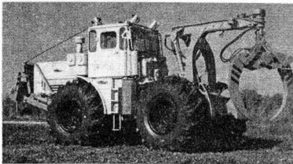
Рис. 8. Колесная бесчокерная трелевочная машина МЛ-30
