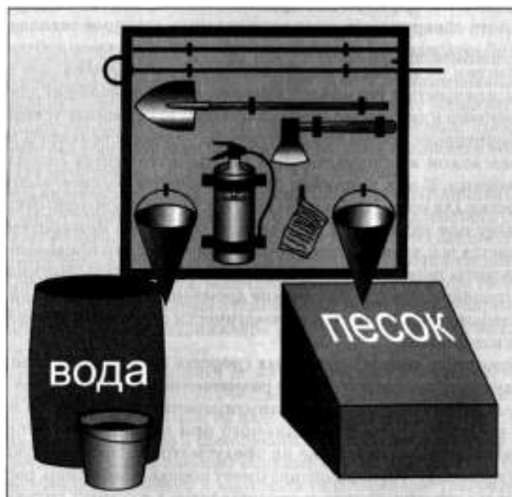
Рисунок 1. Пожарный щит первичных средств пожаротушения
