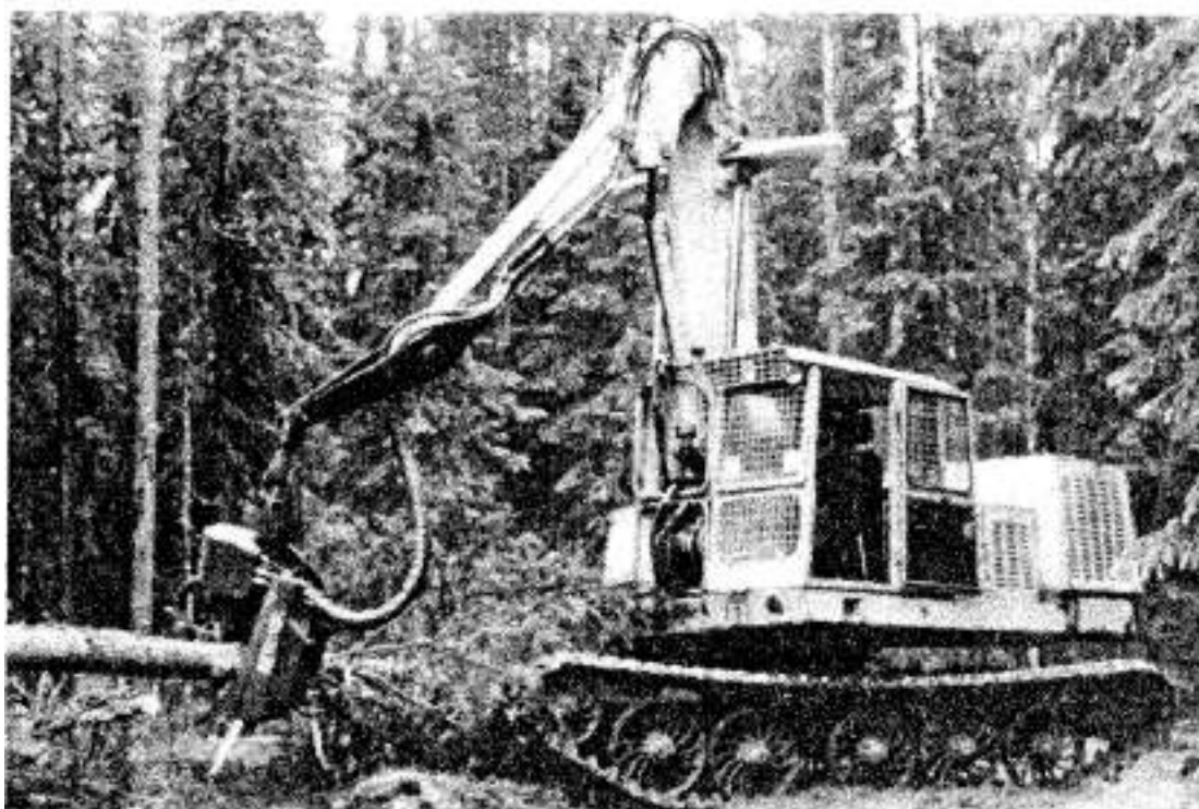
Рис. 2.37. Валочно-сучкорезно-раскряжевочная машина (харвестер) с сучкорезной головкой КЕТО-150
