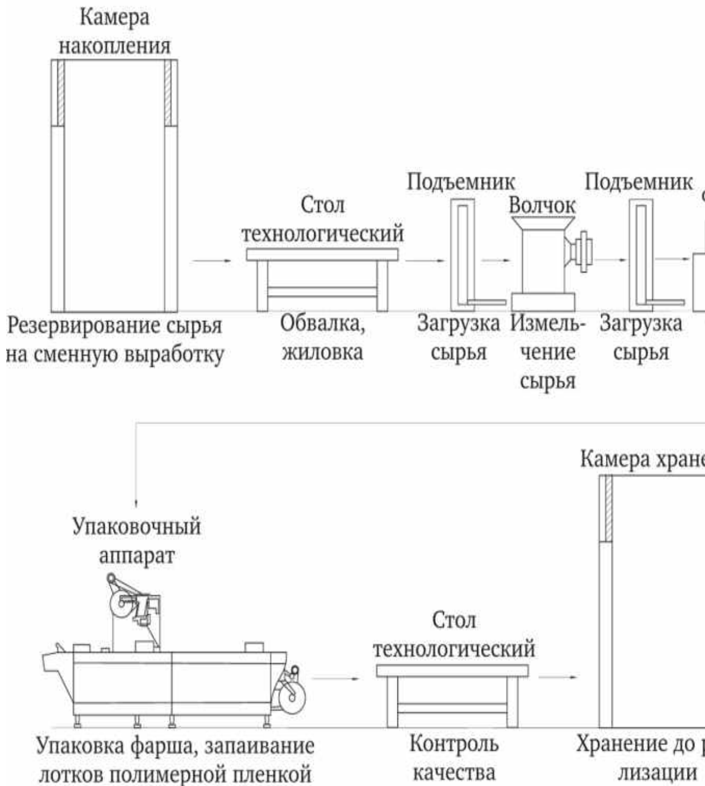
Рис.3. Аппаратурно-технологическая схема производства фаршей
