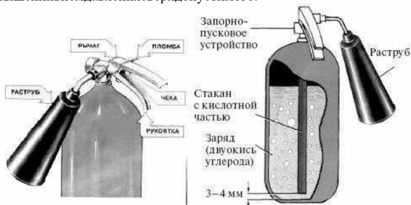
Рис. 2. Углекислотный огнетушитель ОУ-2
