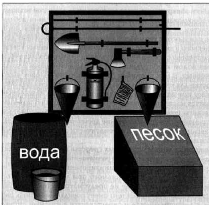
Рисунок 1. Пожарный щит первичных средств пожаротушения
