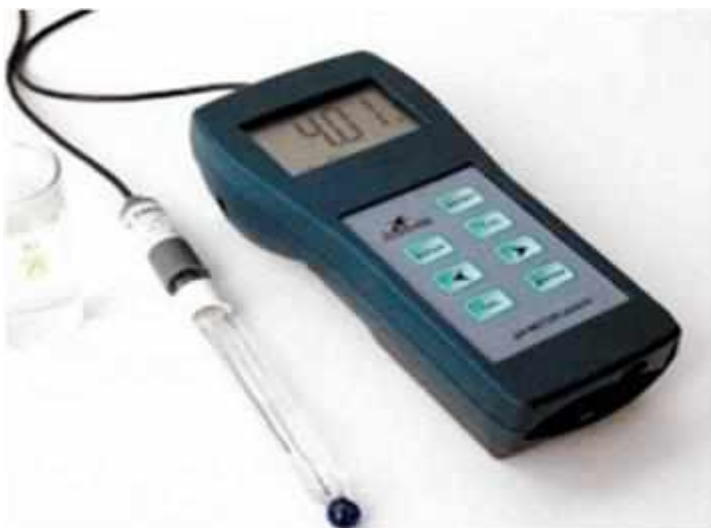
Рис. 1. Портативный рН-метр рН-410
