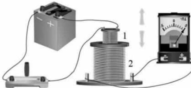
Вам необходимо исследовать, зависит ли направление индукционного тока, возникающего в катушке 2, от величины модуля вектора магнитной индукции, пронизывающего катушку 2. Имеется следующее оборудование:
