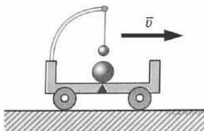
Посередине тележки лежит металлический шарик. Над ним подвешен на нити другой маленький шарик. Пока тележка движется \_\_\_\_\_, шарики покоятся относительно тележки. В некоторый момент времени скорость тележки начала уменьшаться. При этом металлический шарик покатился, а шарик на нити отклонился \_\_\_\_\_ движения тележки (см. рис.). Этот опыт демонстрирует явление \_\_\_\_\_.
