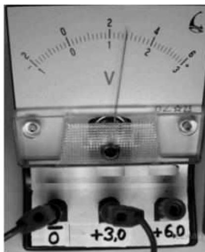
Запишите в ответ показания вольтметра с учётом погрешности измерений. В ответе укажите значение и погрешность измерения слитно без пробела.
