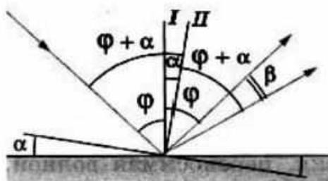
Пусть  $\varphi$  — первоначальный угол падения луча. По закону отражения угол отражения также равен  $\varphi$ , и, следовательно, угол между падающим лучом и отражённым лучом равен  $2\varphi$ .
