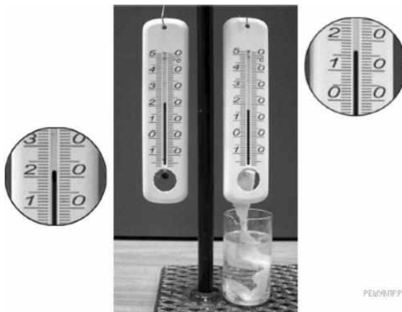
Запишите в ответе показания сухого термометра с учётом погрешности измерений. В ответе укажите значение и погрешность измерения слитно без пробела. Ответ приведите в °С.
