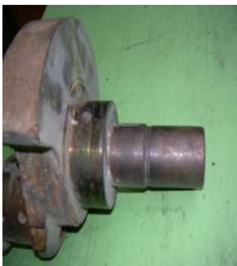
Рисунок 1.10 - Детали, претерпевшие абразивный (а) и гидроабразивный износ (б).
