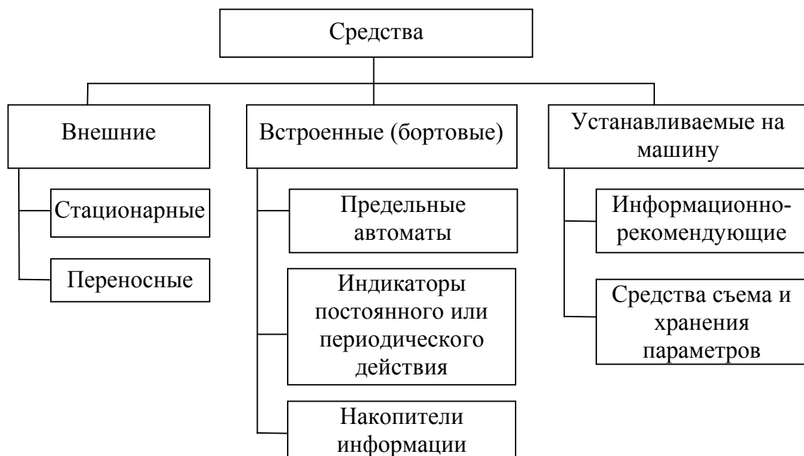
Рис. 4.7. Классификация средств технического диагностирования
