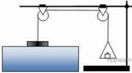
2. Диаметр диска измеряется линейкой и вычисляется его площадь. Затем диск подвешивается к нити и погружается в жидкость так, чтобы она смочила его поверхность. Затем на чашу для грузов, подвешенную к другому концу нити докладываются по одному грузу до того момента, пока диск не оторвется от поверхности жидкости. Сила, вычисляется умножением массы подвешенного груза на ускорение свободного падения.
