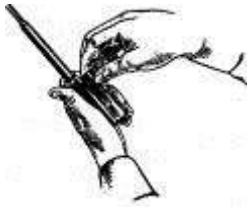
Отделение затвора от затворной рамы
