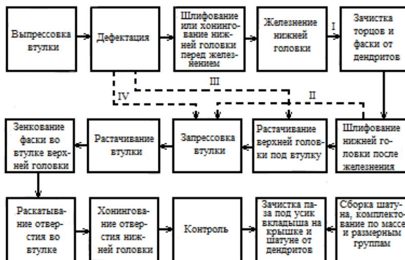
Рисунок 7.9 - Схема маршрутов (I...IV) технологического процесса восстановления шатунов
