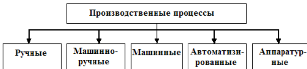
Рисунок 1.– Классификация производственных процессов ремонта в зависимости от степени участия в них человека
