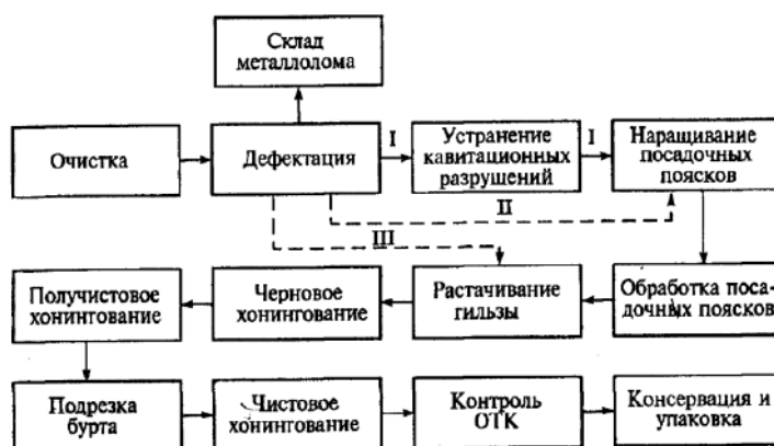
Рисунок 7.6 – Схема маршрутов (I...III) технологического процесса восстановления гильз цилиндров
