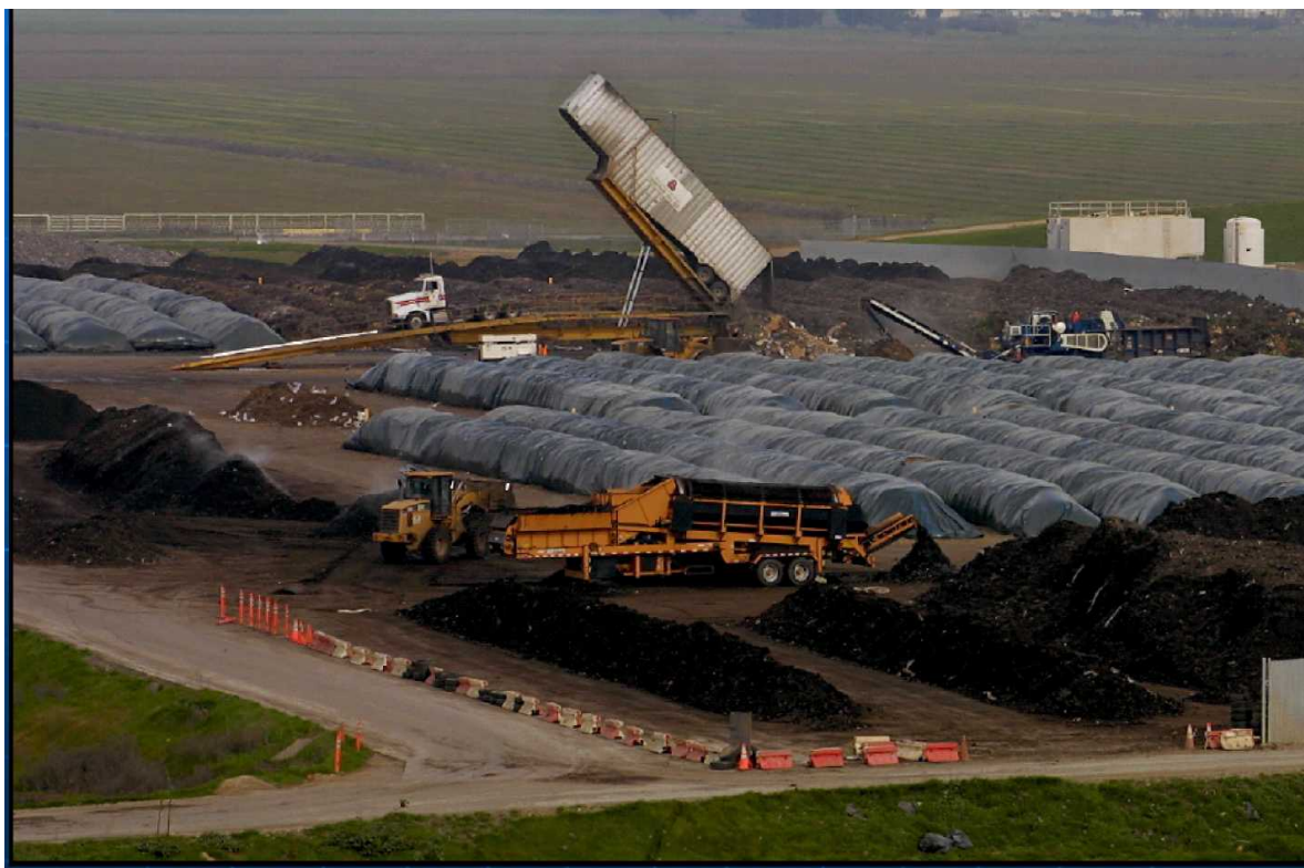
Рис.10. Ускоренная ферментация на открытой площадке: а) система ферментации бурта; б) площадка ферментации
