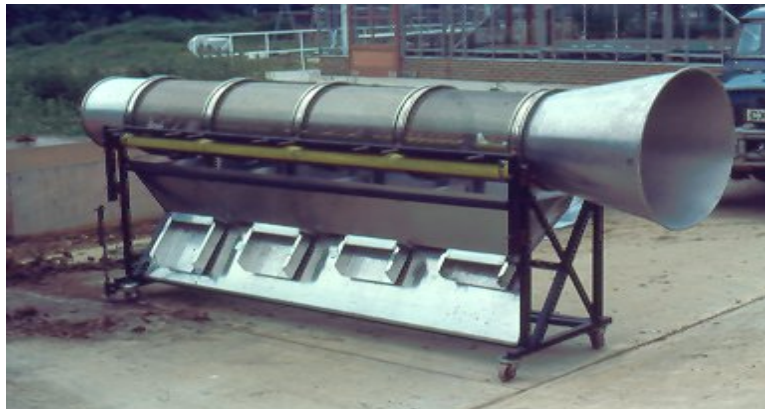
Рис.16. Устройство для просеивания биогумуса
