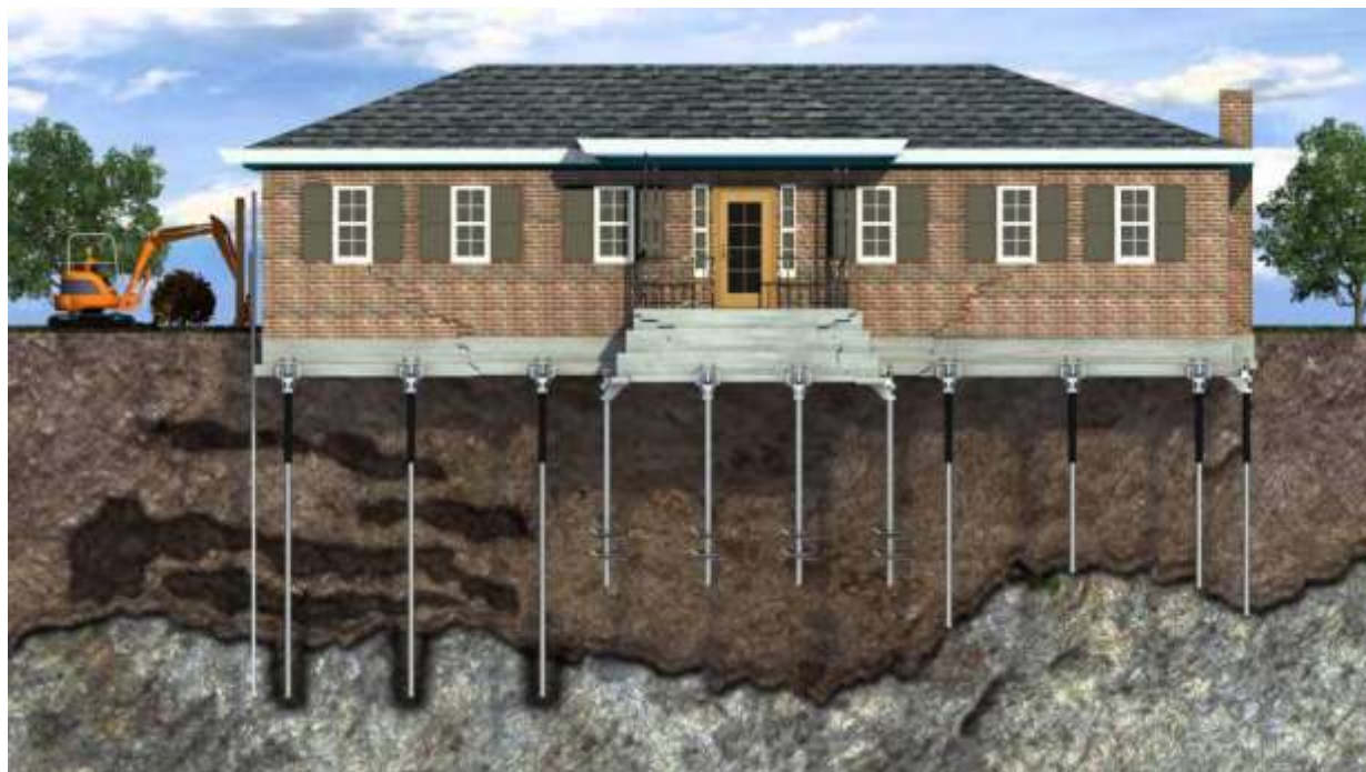
Рисунок 3 – Укрепление фундамента на сложных грунтах
