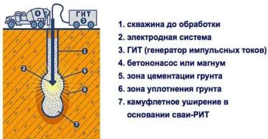
Рисунок 2 – Принцип работы электроразрядной технологии
