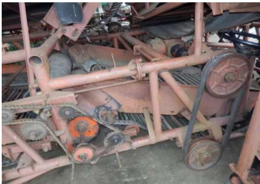
Рисунок 3 – Внутреннее устройство картофелеуборочного комбайна
