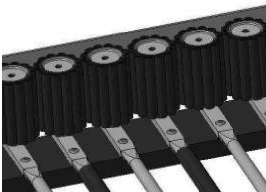
Рисунок 6 – Расположение упругих элементов на сепарирующем устройстве
