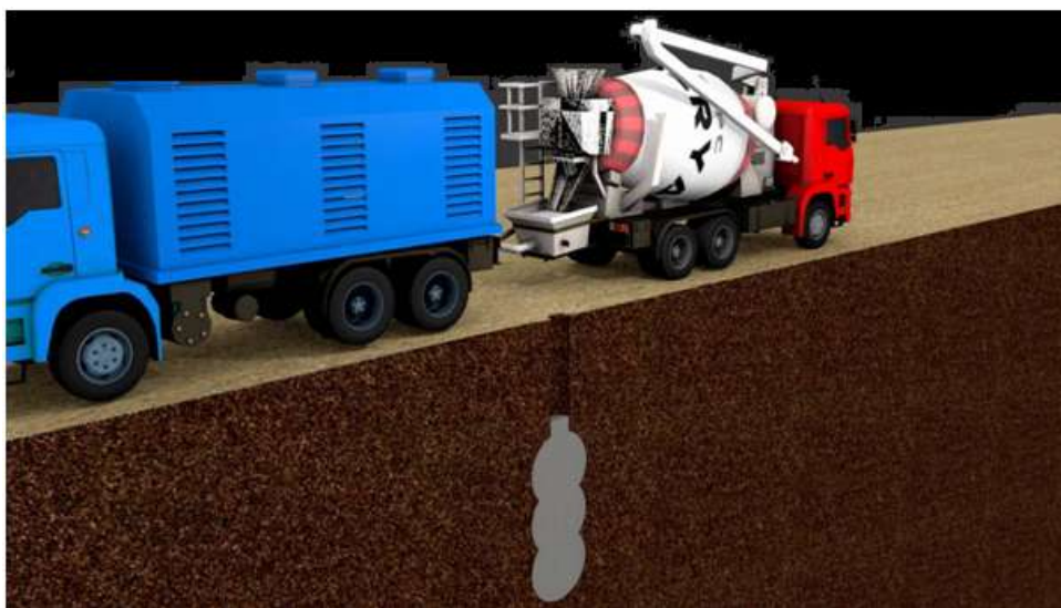
Рисунок 4 – Оборудование при установке свай с использованием ЭРТ
