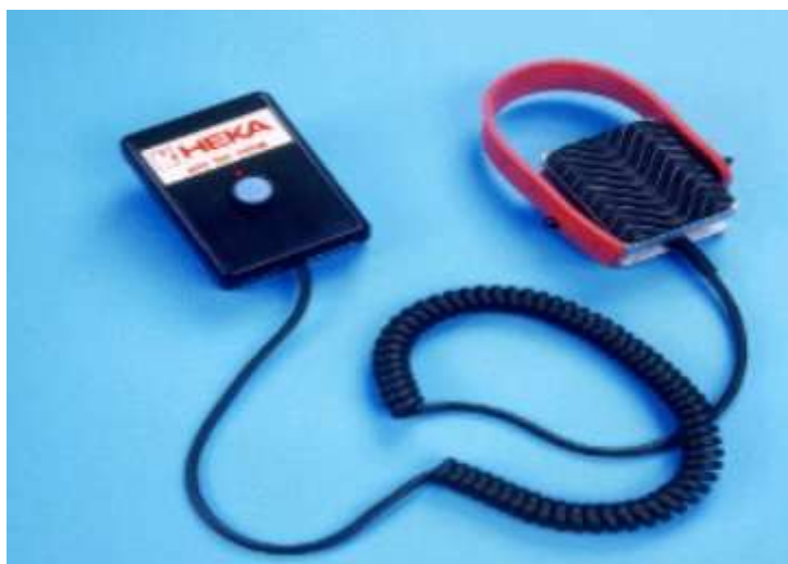
Рисунок 1 – Датчик давления на педаль тормоза
