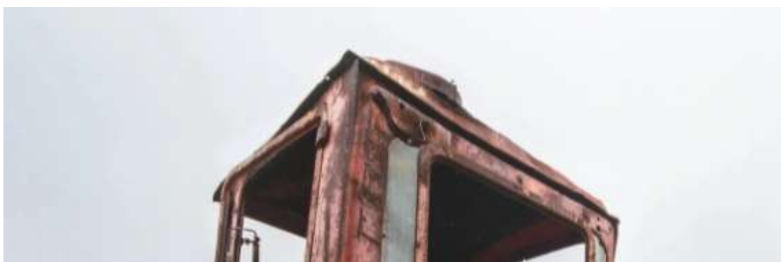
Рисунок 6 – Коррозия кабины трактора
