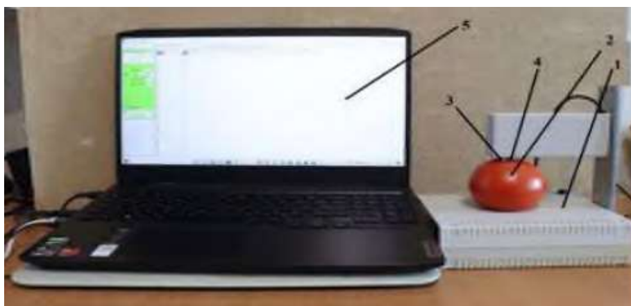
Рисунок 2 – Устройство для оценки зрелости томатов: 1 — прибор для мониторинга зрелости томатов, 2 — исследуемый томат, 3 — источник света (светодиод), 4 — приемник излучения (фотодиод), 5 — компьютер с установленным программным обеспечением [17]
