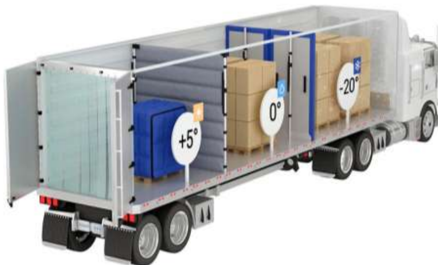
Рисунок 2 – Пример создания условий, подходящих для перевозки различных видов продукции внутри рефрижератора
