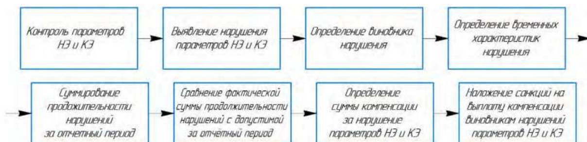
Рисунок 5 – Блок-схема стимулирования электросетевых организаций и потребителей к повышению надёжности (НЭ) и качества электроэнергии (КЭ) [15]
