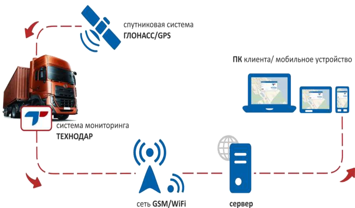
Рисунок 2 – Схема работы системы мониторинга
