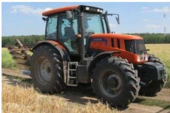
Рисунок 1 – Опытный пахотный агрегат АТМ 3180 «Terrion» + ПЛН-5-35
