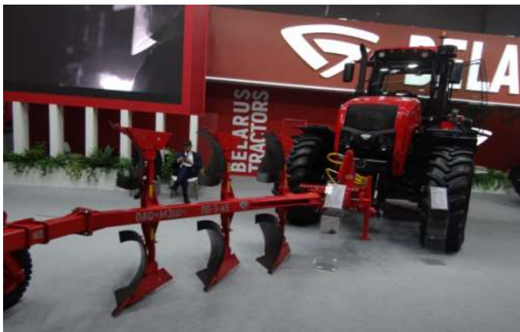
Рисунок 2 – Плуг ПП-3-45 ОАО «Минский завод шестерен» для передней навески трактора
