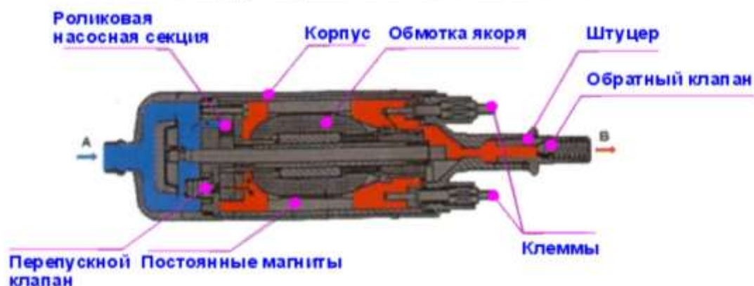
Рисунок 3 – Конструкция электрического бензонасоса
