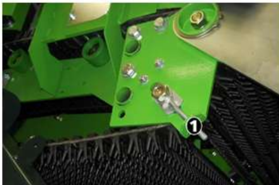
Рисунок 3 – Натяжение линейного ежного транспортёра
