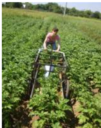
Рисунок 3 – Экспериментальная установка для сбора колорадских жуков на дачном участке
