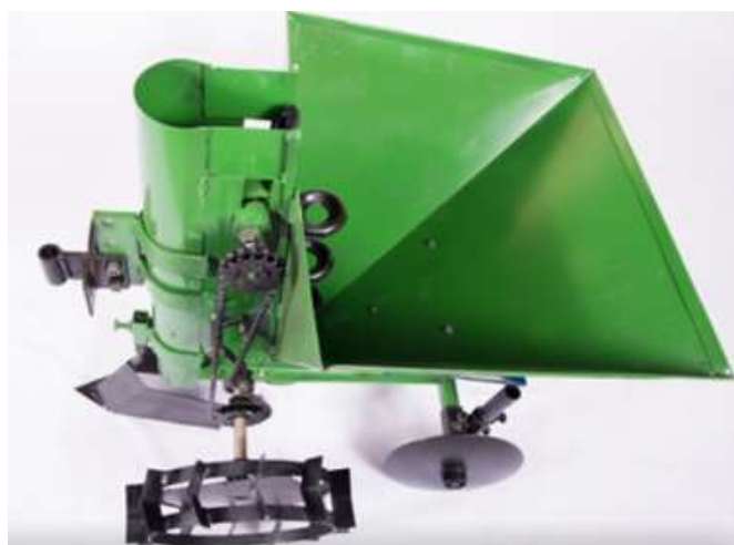
Рисунок 1 – Картофелесажалка КС-100 Изготовитель «Предприятие ООО «БелТрактора»
