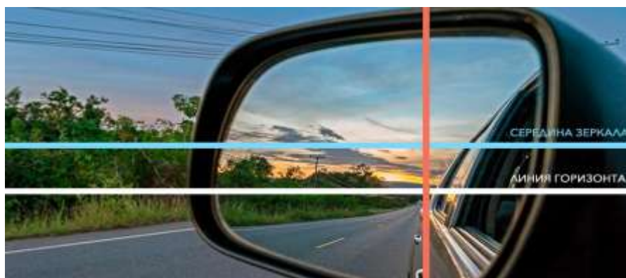
Рисунок 3 – Регулировка бокового зеркала
