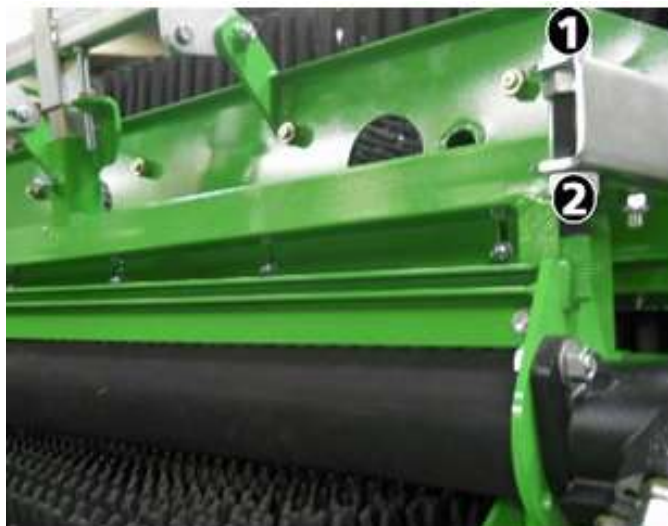
Рисунок 7 – Регулирование высоты отражающих роликов
