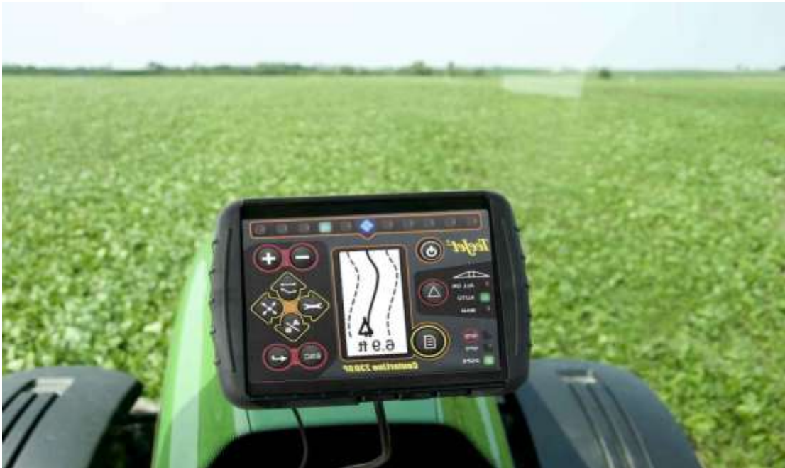
Рисунок 2 – Трактор, оборудованный системой GPS
