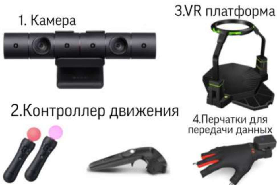
Рисунок 3 – Оборудование для использования виртуальной реальности: 1 – камера, 2 – контроллер движения, 3 – VR платформа, 4 – перчатки для передачи данных
