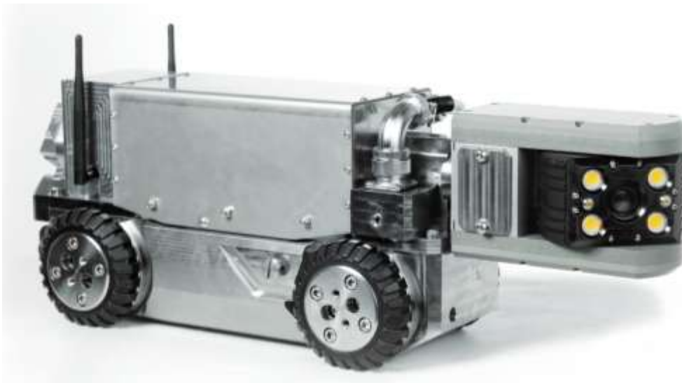
Рисунок 2 – Робот для телеинспекции труб Sigma-250A
