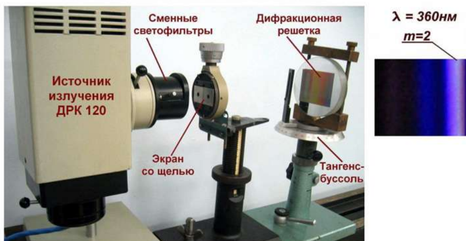
Рисунок 3 – экспериментальная установка для определения чувствительности фотоаппарата к излучению ультрафиолета
