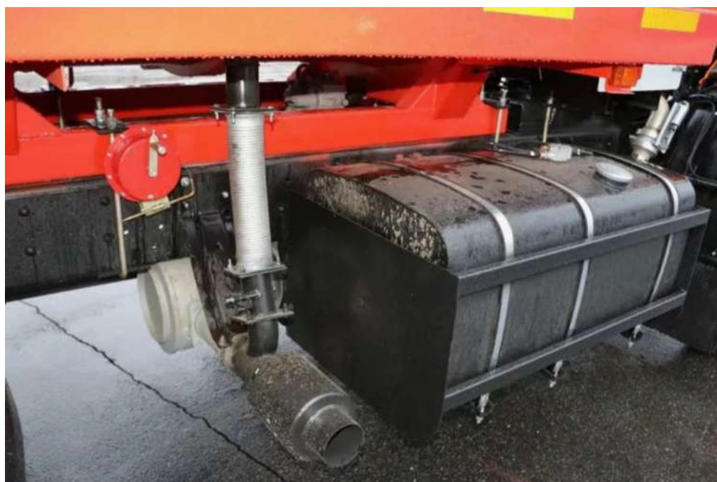
Рисунок 3 – Система обогрева кузова самосвала-сельхозника отработавшими газами
