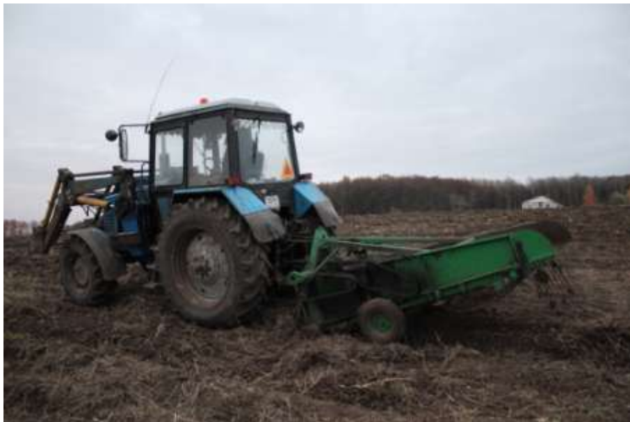
Рисунок 3 – Экспериментальный копатель КТН-2В с лопастным интенсификатором
