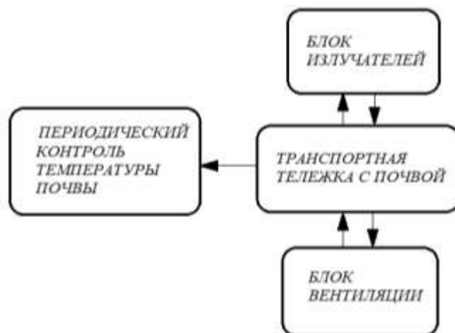
Рисунок 1 – Структурная схема стационарной машины для обеззараживания почвы
