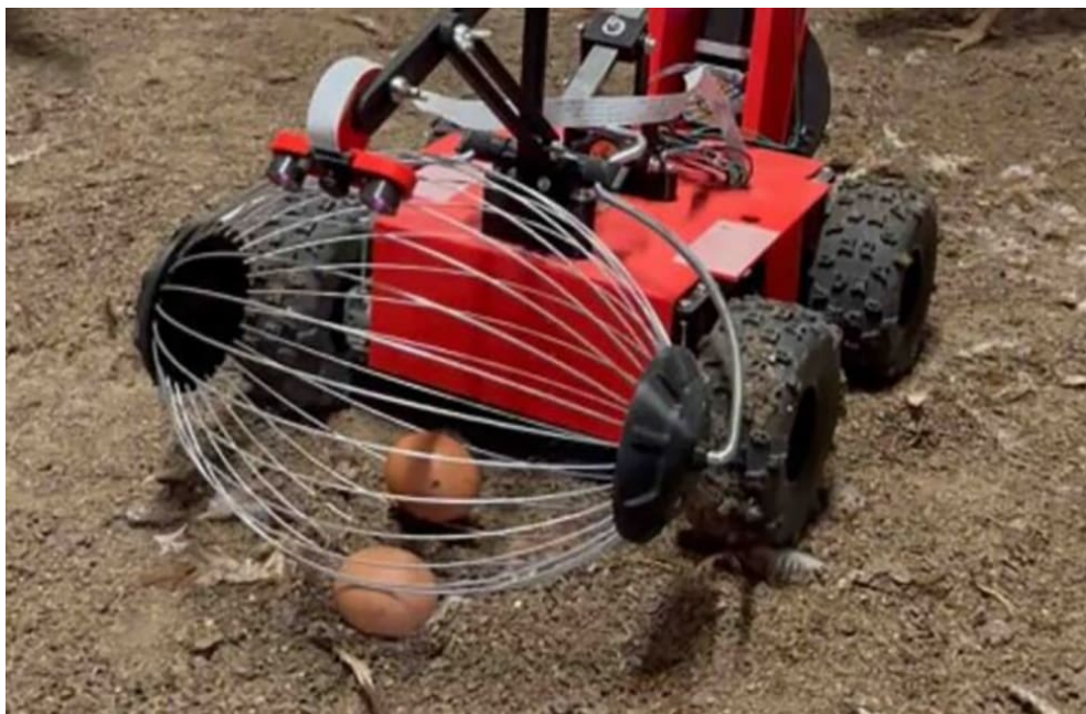
Рисунок 2 – Мобильный робот для сбора яиц с использованием платформы компьютерного зрения
