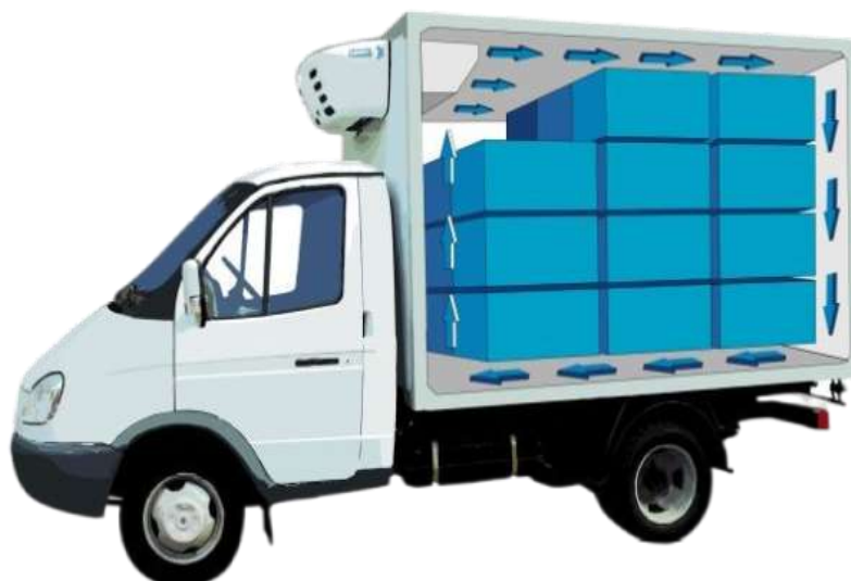
Рисунок 1 – Работа рефрижераторной установки
