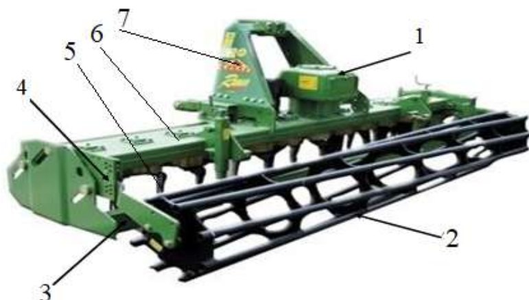
1- редуктор, 2- прикатывающий каток, 3- выравнивающий брус, 4-механизм регулирования глубины, 5- ножи, 6-несущую раму, 7-механизм навески Рисунок 1 – Вертикально-фрезерный культиватор Celli Ranger 300
