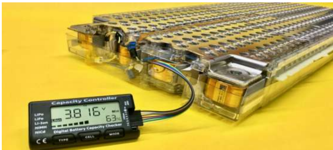
Рисунок 2 – Модуль аккумулятора электромобиля Tesla
