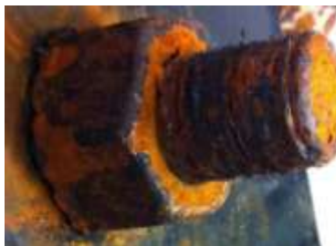
Рисунок 3 – Щели и продукты коррозии на концах болтов и шпилек
