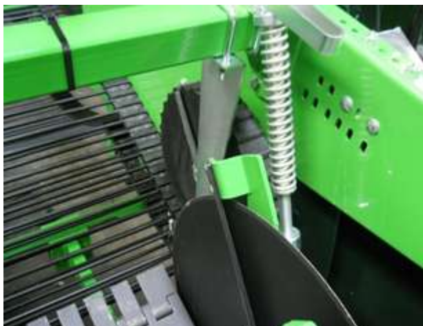
Рисунок 7 – Регулирование глубины погружения режущих дисков в почву
