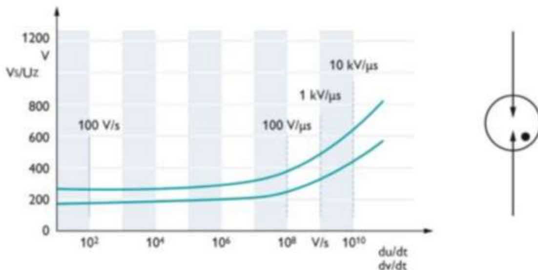
Рисунок 3 – Пробивная характеристика защитного разрядника
