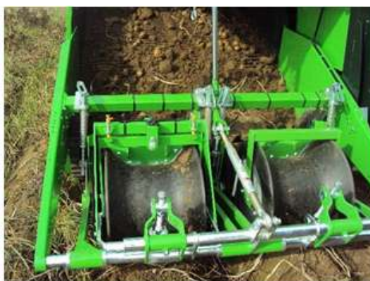
Рисунок 2 – Положение подкапывающей секции
