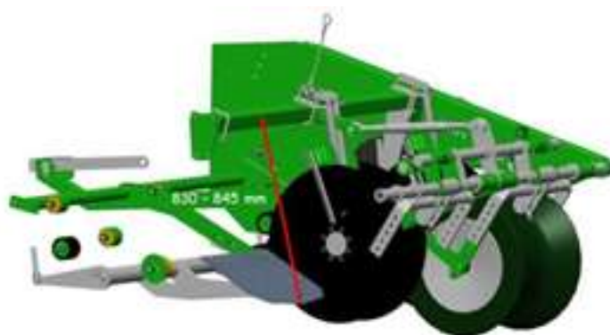
Рисунок 5 – Регулирование поворотных колес
