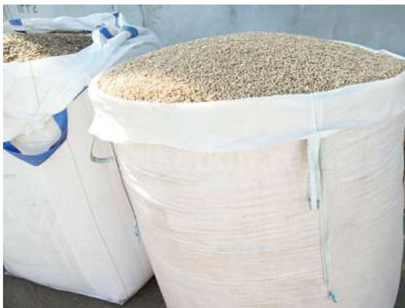
Рисунок 3 – Общий вид мягкого контейнера с комбикормом типа биг-бэг
