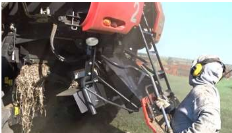
Рисунок 4 – Использование сжатого воздуха для удаления растительного материала из измельчителя
