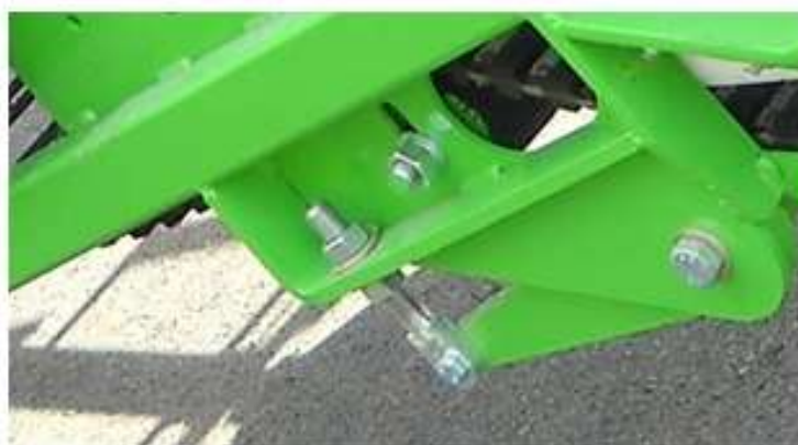
Рисунок 6 – Регулировка наклона подкапывающих лемехов
