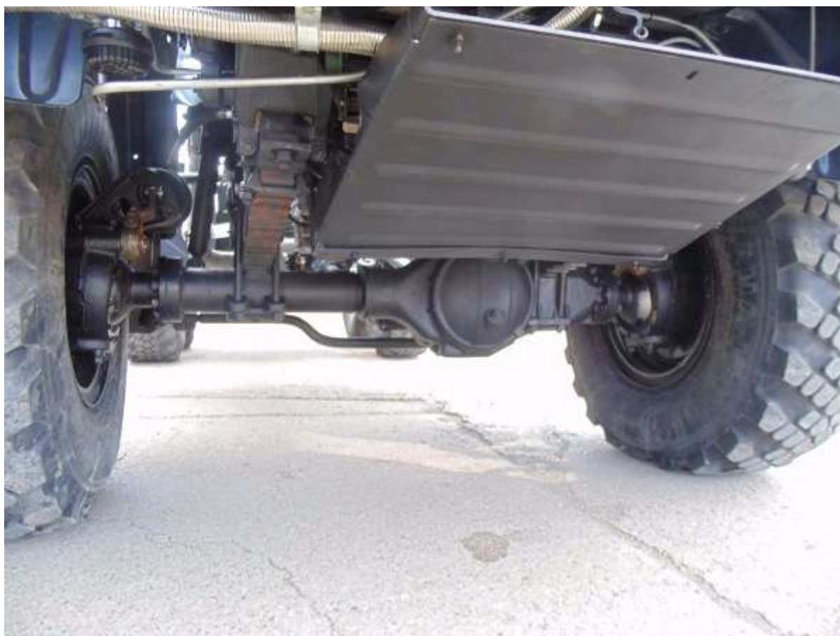
Рисунок 2 – Общий вид моста управляемых колес КАМАЗ-5350
