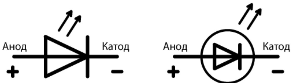
Рисунок 2 – Обозначение светодиода на электрической схеме
