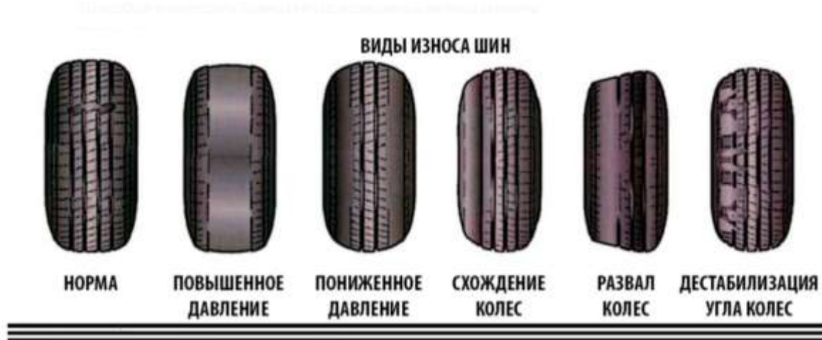
Рисунок 1 – Виды износа шин
