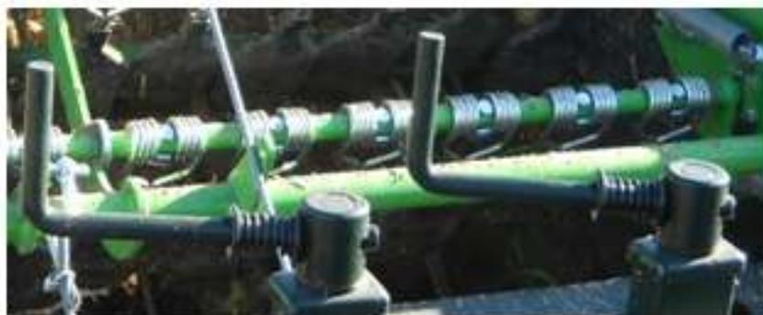
Рисунок 7 – Регулирование отделения картофеля от ботвы и его транспортировки на просеивающий транспортер
