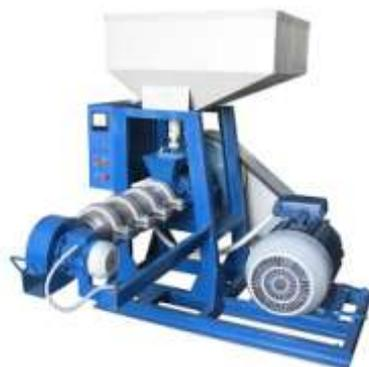
Рисунок 2 – Экструдер кормовой [16,17]
