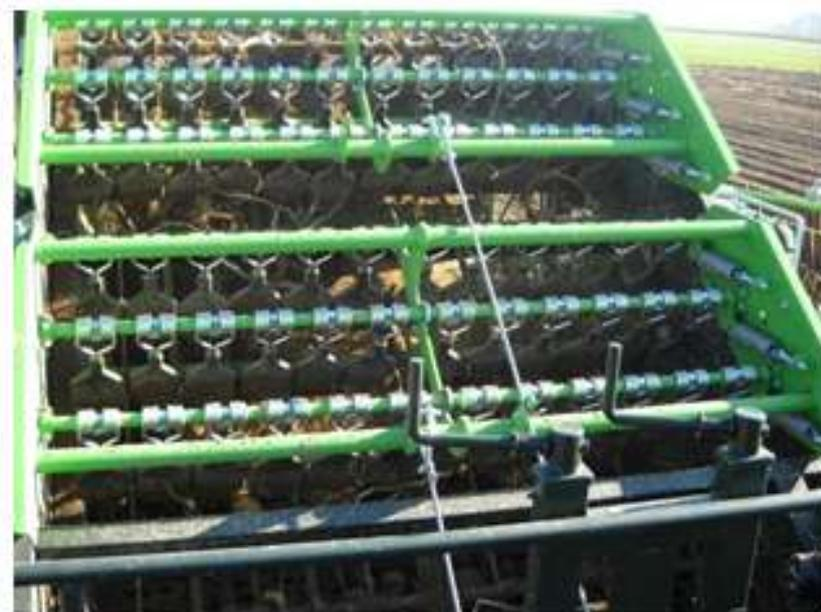
Рисунок 5 – Ботвоотводящий транспортер с ботвозадерживающими пальцами
