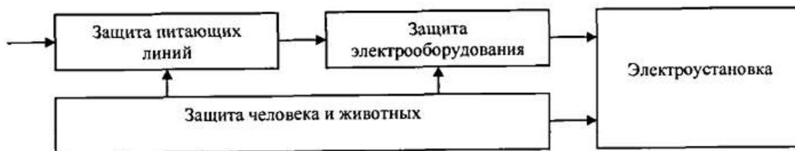
Рисунок 1 – Система защит электрооборудования производственного помещения [16]
