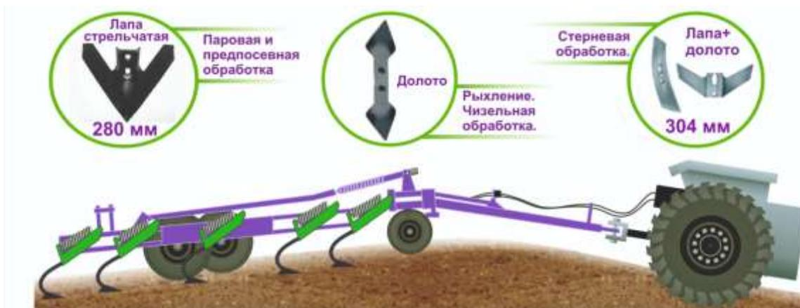
Рисунок 13 – Схема обработки почвы чизельной лампы
