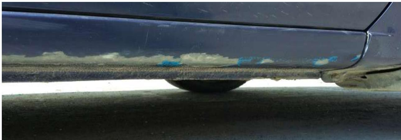
Рисунок 4 – Пример быстрого износа лакокрасочного покрытия на автомобиле LADA
