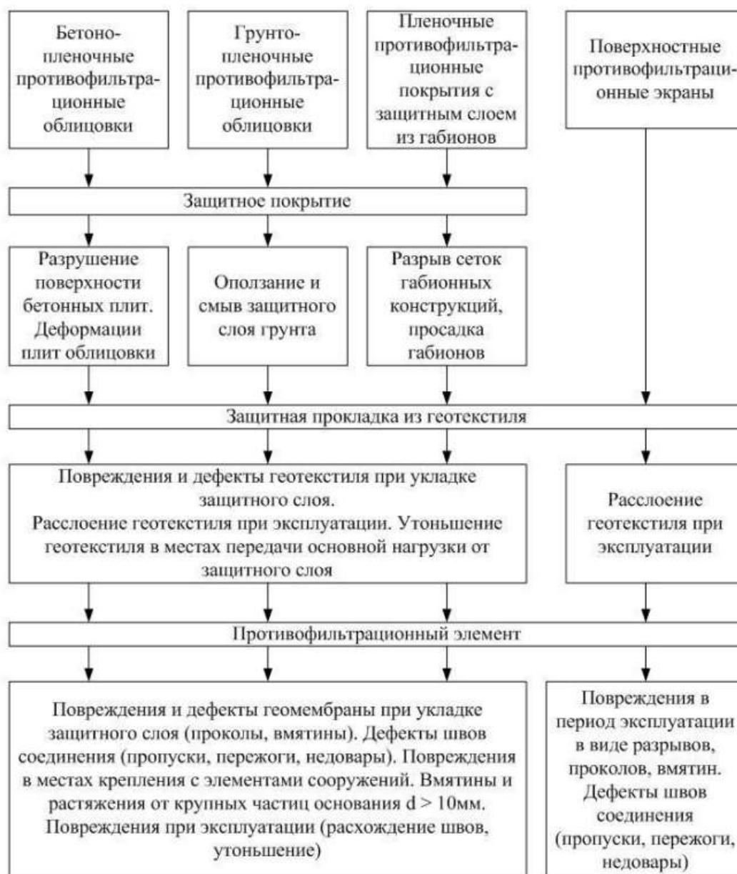
Рисунок 1 – Возможные отказы конструктивных элементов
