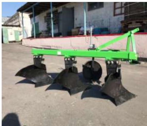
Рисунок 8 – Плуг с перьевыми отвалами и углоснимами, демонстрирующий инновационные технологии
