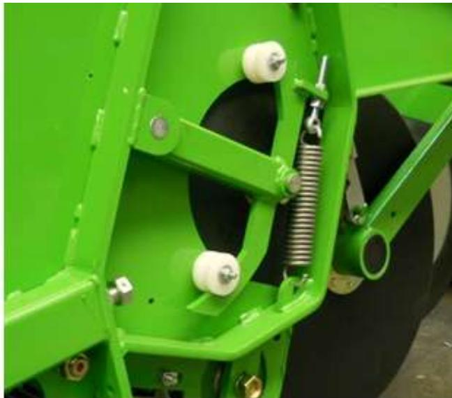
Рисунок 1 – Защемление ботвы ботвозахватывающими роликами
