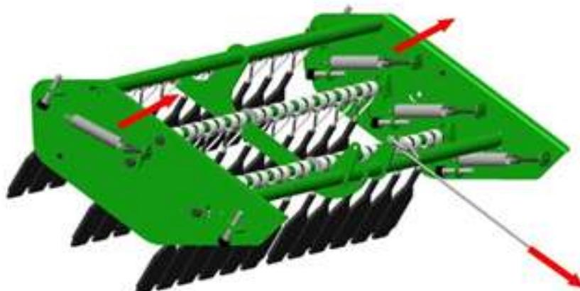
Рисунок 8 – Регулирование ботвозадерживающими пальцами
