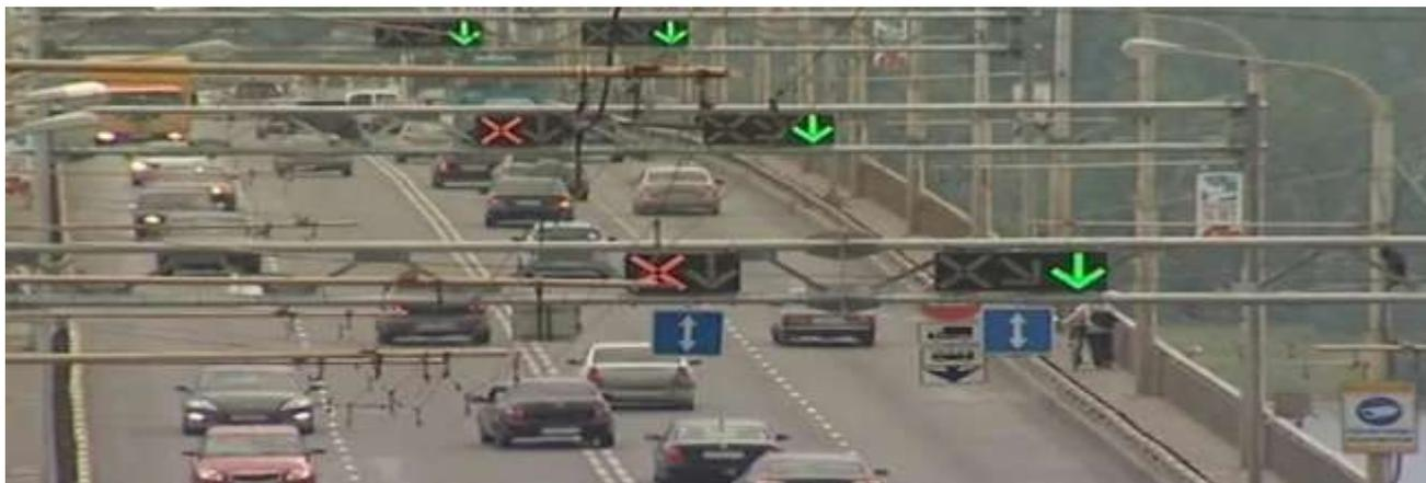
Рисунок 4 – Пример дороги с реверсивным движением
