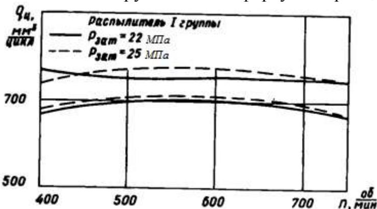
Рисунок 6 – Зависимость цикловой подачи топлива скоростного режима работы системы при различных величинах затяжки пружины иглы форсунки
