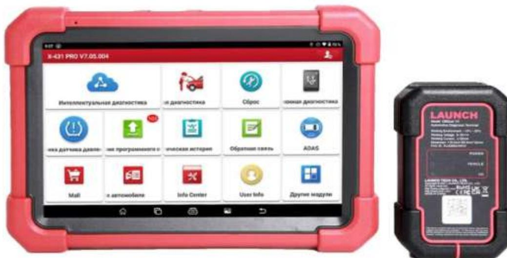
Рисунок 3 – Планшет, применяемый для проведения технического обслуживания автомобилей
