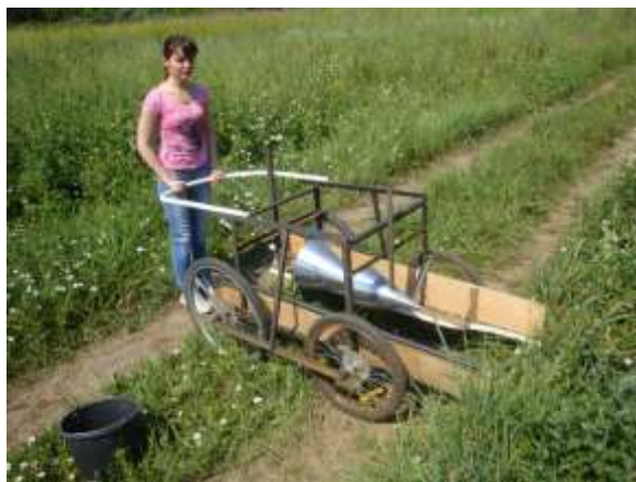
Рисунок 2—Установка для сбора вредных насекомых с растений картофеля
