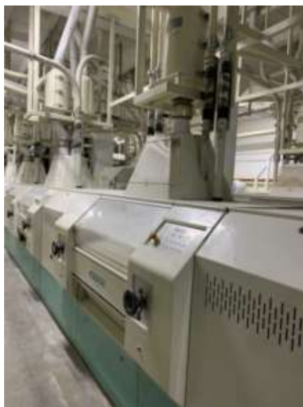
Рисунок 3 – Четырёхвалковая мельница на ООО «Русские мельницы»
