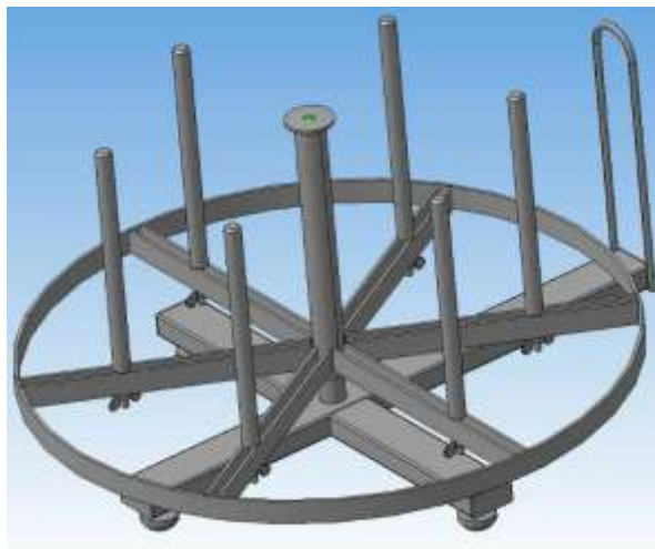
Рисунок 2 – Предлагаемый вариант бухты для мобильного дорожного покрытия
