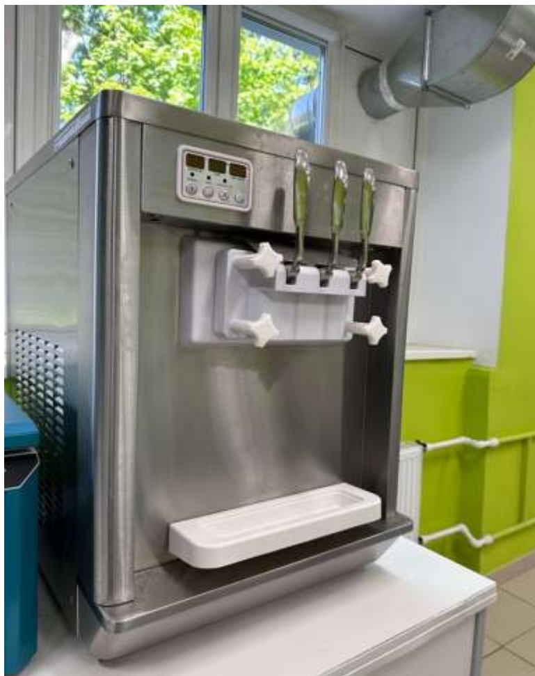
Рисунок 1 – Внешний вид Фризера НІМ-03 для мягкого мороженого
