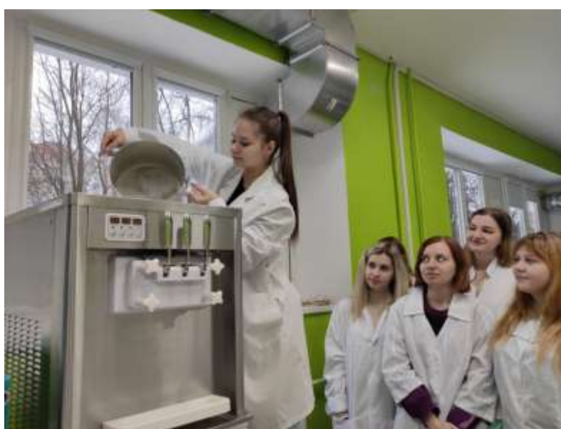
Рисунок 2 – Заполнение бункеров смесью для мягкого мороженого
