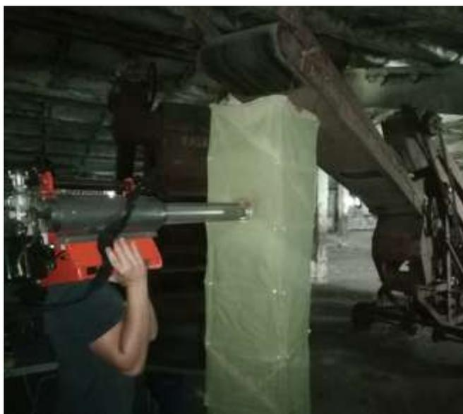
Рисунок 2 – Устройство для предпосевной обработки семян горячим туманом гуматов
