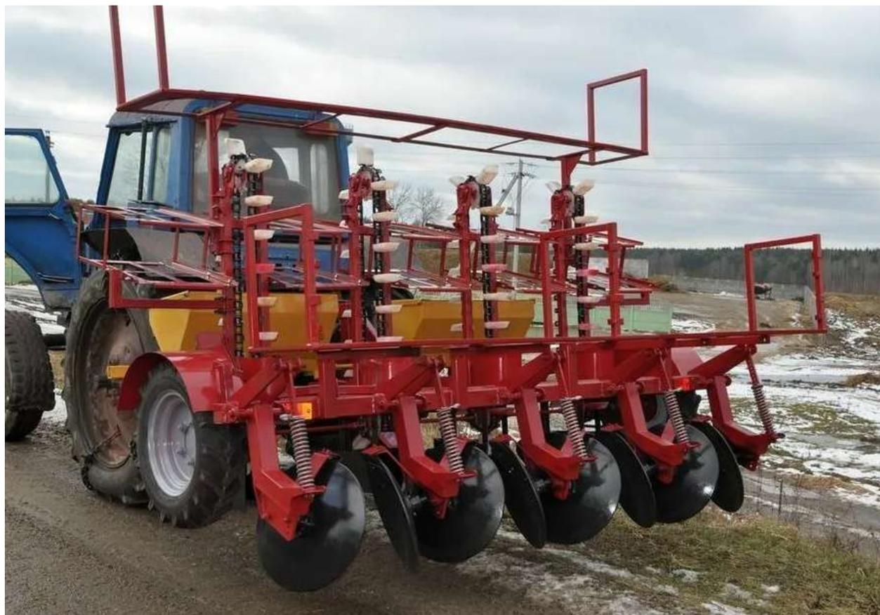
Рисунок 2 – Картофелесажатель прицепной
