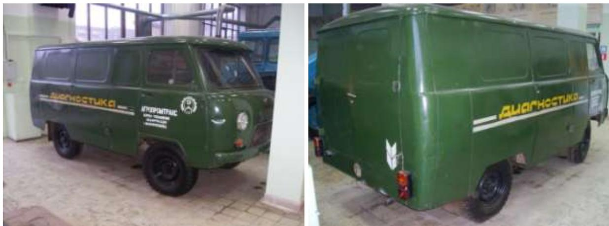
Рисунок 1 – Фото экспериментального образца диагностического мобильного комплекса на базе автомобиля УАЗ-3741
