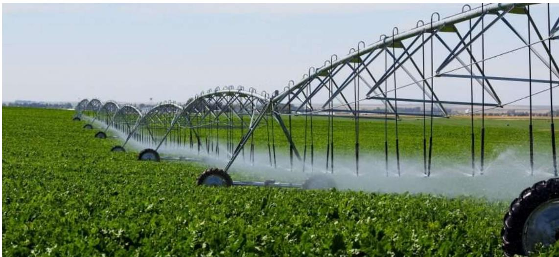
Рисунок 1 – Общий вид многоопорной дождевальной машины «Кубань-ЛК1»
