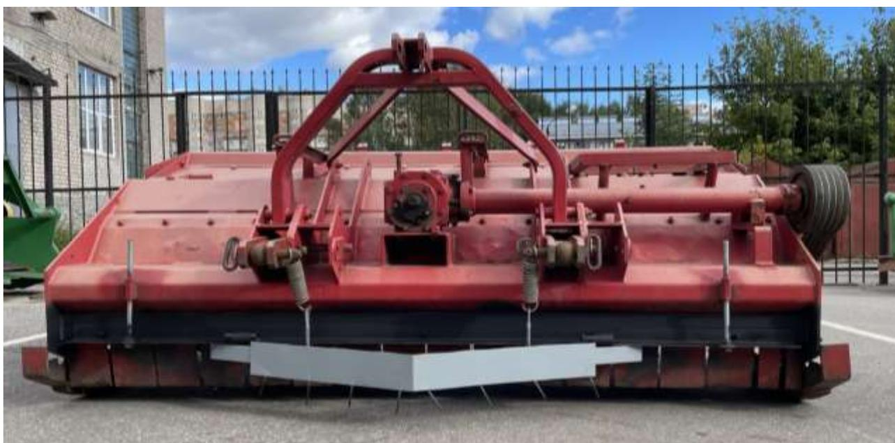
Рисунок 1 – Измельчитель – мульчировщик с разравнивающим устройством
