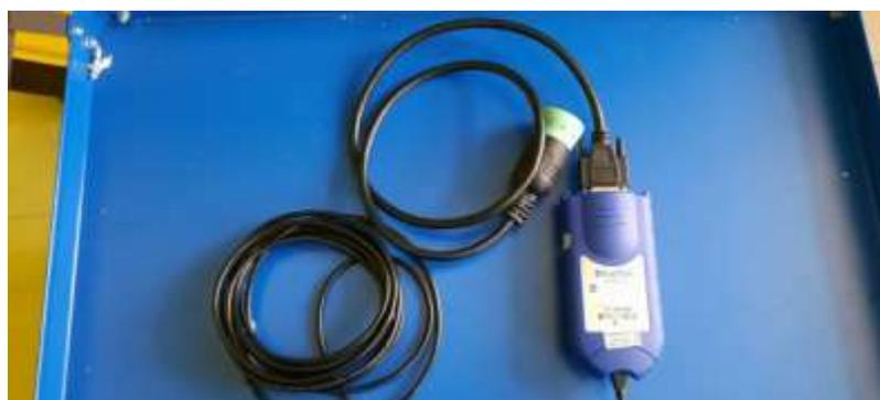
Рисунок 3 – Диагностическое оборудование комплекса – диагностический сканнер BlueTek для тракторов компании John Deere
