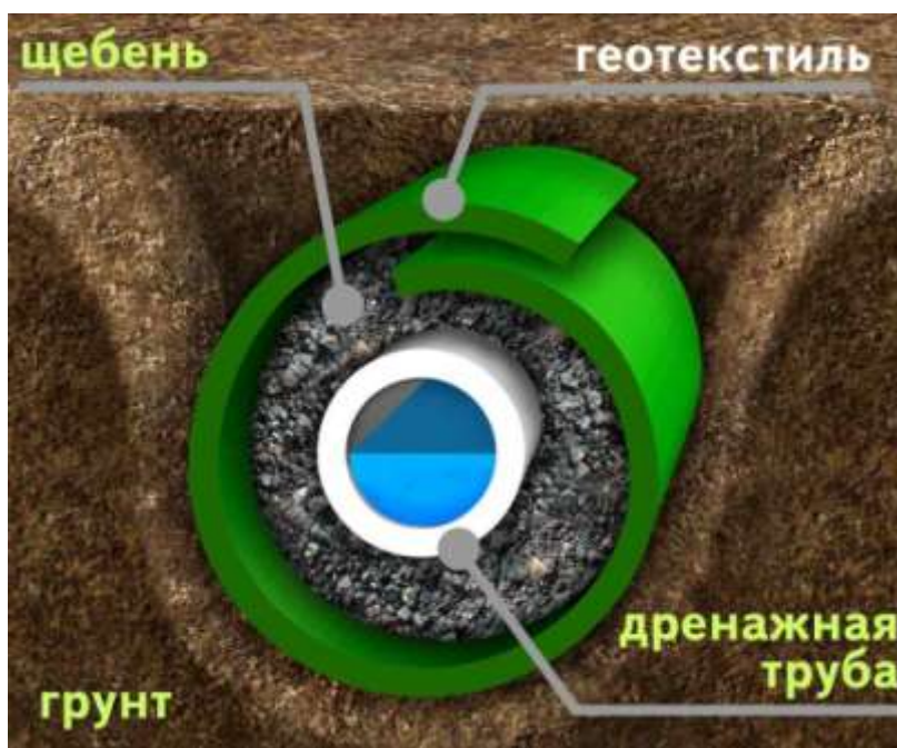
Рисунок 1 – Схема закрытого дренажа
