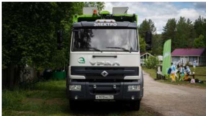
Рисунок 2 – Электрический грузовик «Урал-С230Е5» с гибридной силовой установкой
