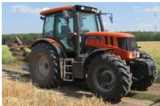
Рисунок 1 – Опытный пахотный агрегат АТМ 3180 «Terrion» + ПЛН-5-35
