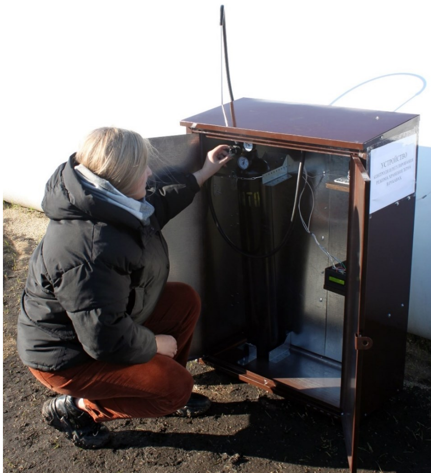
Рисунок 1 – Подготовка экспериментального образца устройства контроля и регулирования режима хранения зерна в рукавах к работе
