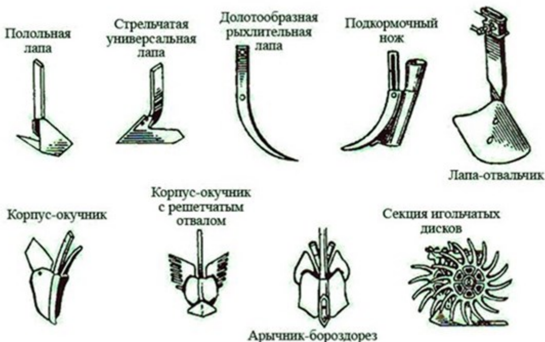
Рисунок 3 – Типы рабочих органов (лап) культиваторов
