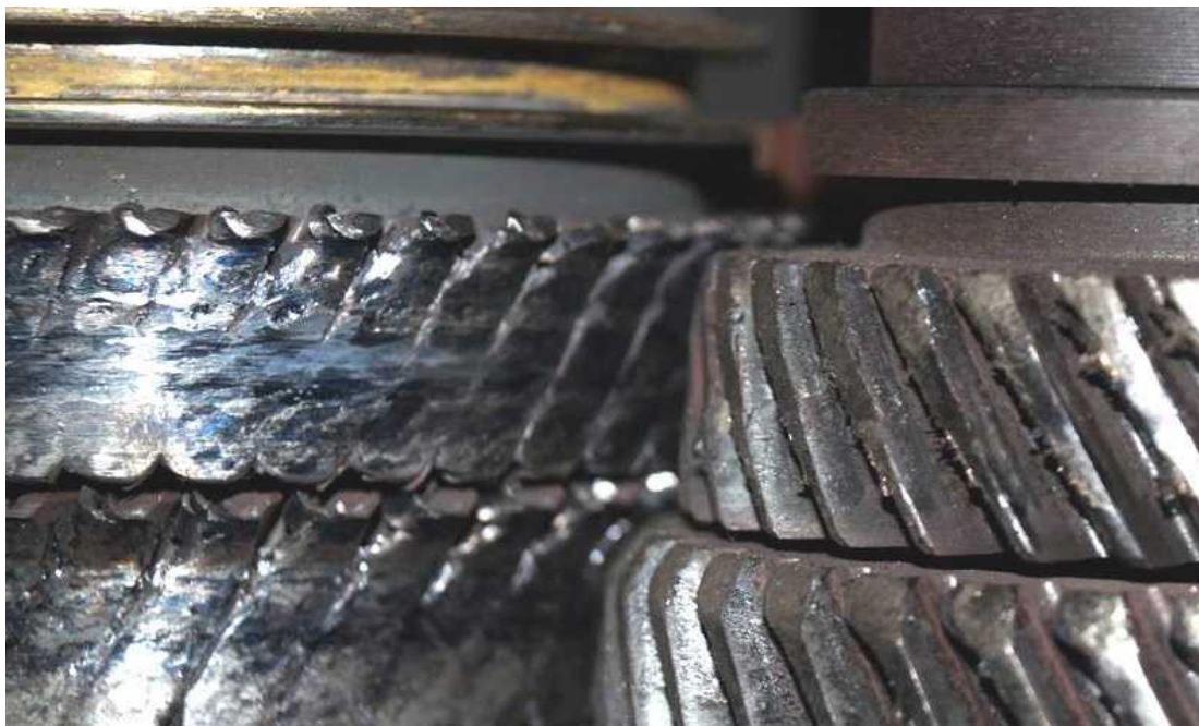
Рисунок 2 – Смятие зубьев у шестерен
